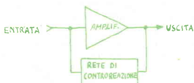
Fig. 1 - Come si rileva da questo schema a blocchi, un oscillatore è essenzialmente costituito da un amplificatore e da un circuito di controreazione.
