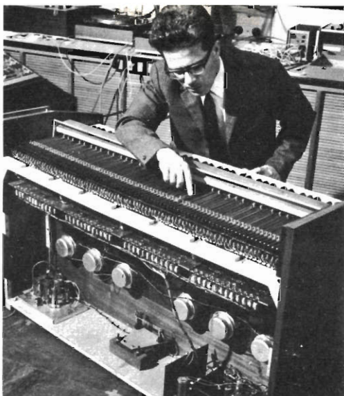
Fig. 3 - Vista interna del pianoforte elettronico. (Documentazione Philips)
