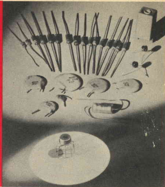
Fig. 4 - Il circuito integrato della RCA, visibile in basso al centro del cerchio di luce, può svolgere le stesse funzioni di tutti i componenti elettronici disposti sullo sfondo.
