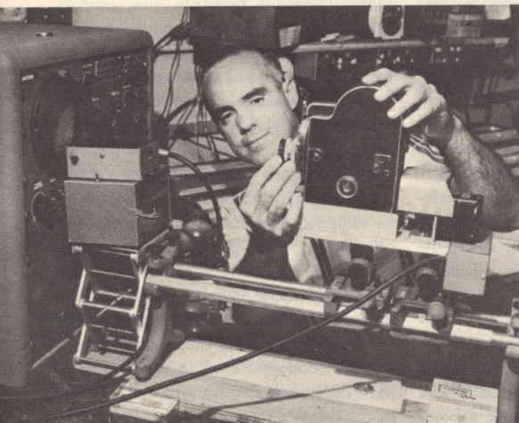
Il dott. Smith della facoltà di radioastronomia dell'Università della Florida regola una cinepresa da 16 mm per filmare i segnali di Giove presentati sullo schermo di un oscilloscopio.
