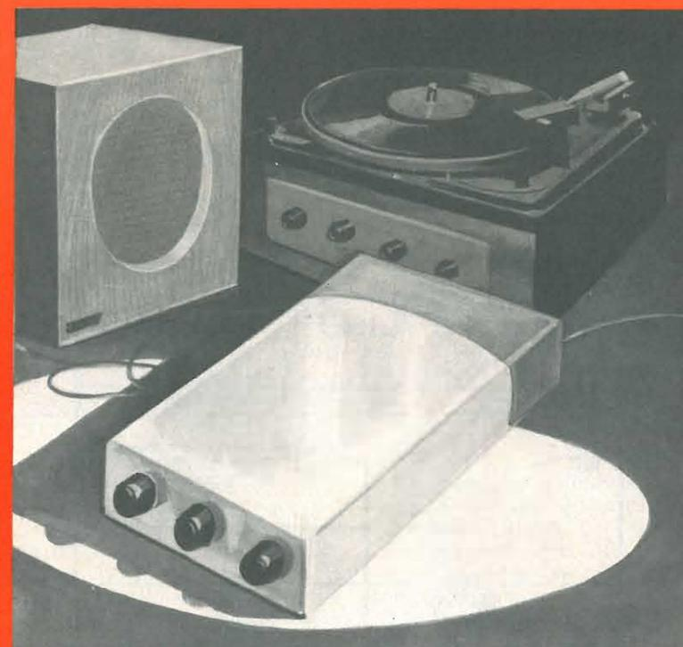
**E' privo di trasformatore d'uscita ed eroga una potenza massima di 2 W con una distorsione del 10% alla frequenza di 100 Hz.**
