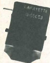
Dai cervelli elettronici ai circuiti del dilettante i moduli a stato solido (o affogati) sono una meraviglia dell'elettronica moderna. Piccoli, compatti, questi blocchetti di resina racchiudono dei circuiti più o meno complessi che danno modo, con pochi altri elementi e poco tempo, di costruire apparecchiature elettroniche fra le più disparate.
