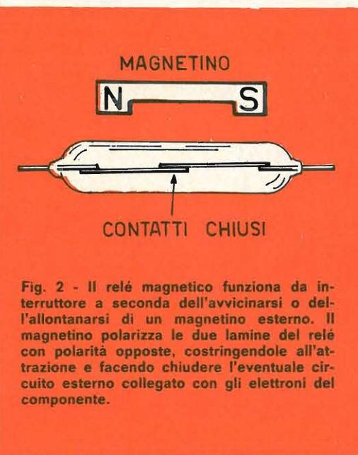
Fig. 2 - Il relé magnetico funziona da interruttore a seconda dell'avvicinarsi o dell'allontanarsi di un magnetino esterno. Il magnetino polarizza le due lamine del relé con polarità opposte, costringendole all'attrazione e facendo chiudere l'eventuale circuito esterno collegato con gli elettroni del componente.
