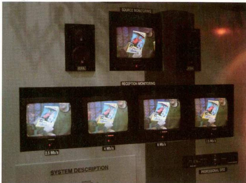
Thomson Broadcast Systems : Image «monitor» (en haut) et images avec différents débits d'information ; de gauche à droite : 2,5 ; 4 ; 6 ; 7,5 Mbits/s.
