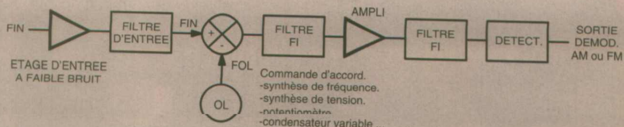
■ Figure 1 : synoptique d'un récepteur classique.
