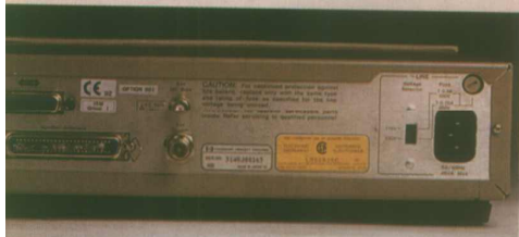
La face arrière avec les connecteurs IEEE et manipulateur externe ainsi que les prises BNC pour les entrées trigger et bias.
