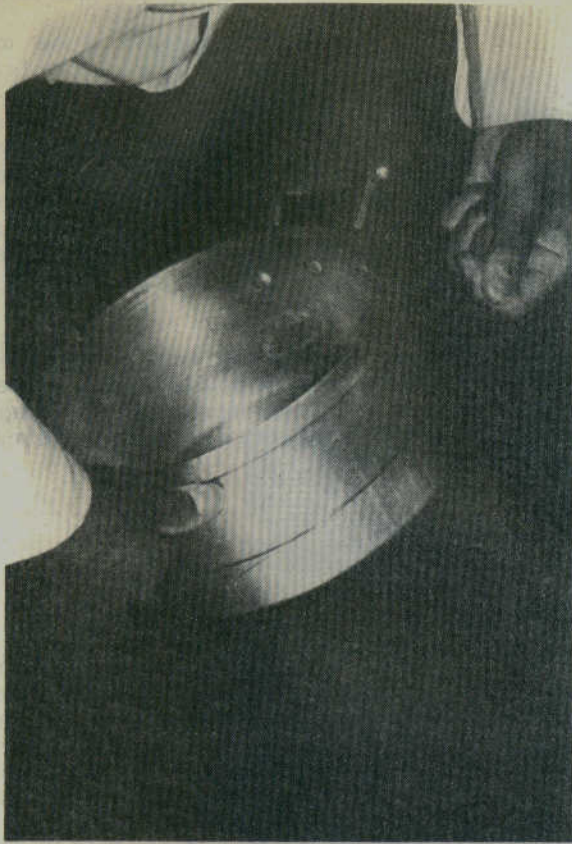
Réalisation de la bobine de détection. L'utilisation d'une casserole ou d'un fait-tout semble tout indiquée.
