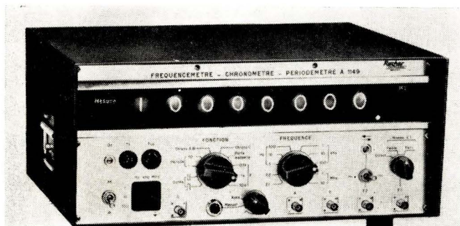
A gauche, fréquence-mètre - chronomètre - périodemètre A-1149 de ROCHAR ; à droite, millivoltmètre AE-100 pour mesure de tensions et courants continus de FÉRISOL.
