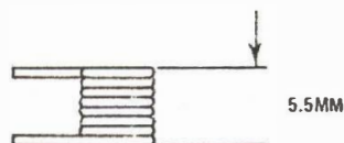
L4, 2 spire + 3/4 con filo \varnothing=0,55 mm.
