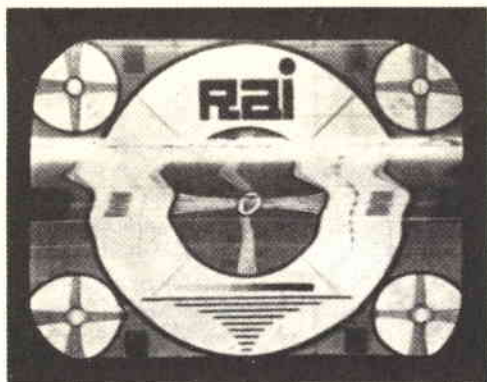
Fig. 5 - Se il disturbo è rilevante si possono produrre deformazioni al passaggio della riga bianca, come si nota chiaramente in questa foto.
