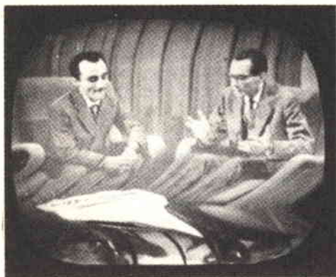
Fig. 7 - In altri casi si notavano delle ondulazioni sulle immagini. Anche in questo caso, bastò applicare il filtro di cui si parla nell'articolo, per eliminare totalmente l'inconveniente.
