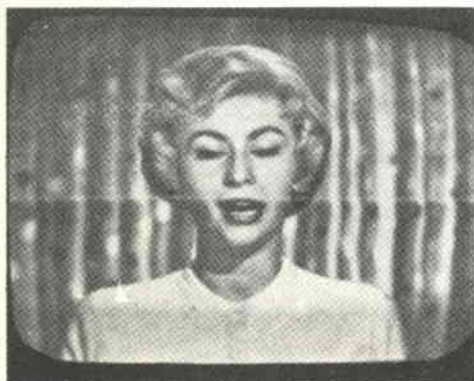
Fig. 1 - Se notate che la parte superiore dell'immagine appare più chiara, allora potrete esser certi che il disturbo è provocato da una lampada fluorescente.
