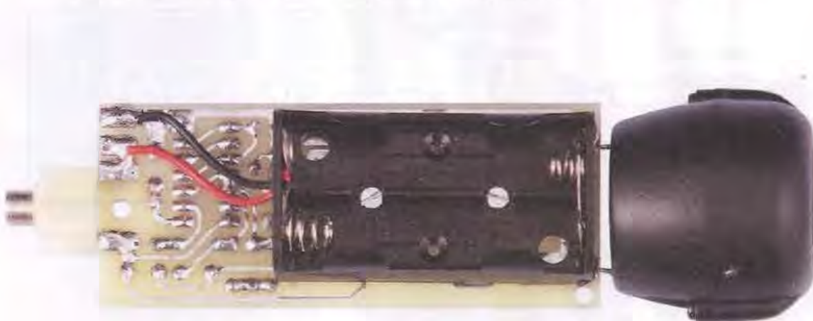
Fig.7 In questa foto è riprodotto il circuito della sirena a montaggio ultimato. Questo esemplare è stato utilizzato nel corso dei nostri test.
