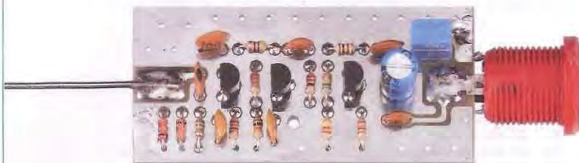
Fig.3 Schema pratico di montaggio dell'LX.1777. La lunghezza dello stilo antenna che in questo disegno è appena accennato, può essere anche superiore a 1 metro da noi suggerito. Ovviamente anche il relativo tubo di protezione dovrà avere una lunghezza adatta a contenerlo insieme al circuito amplificatore. Sotto, foto del circuito a montaggio ultimato.
