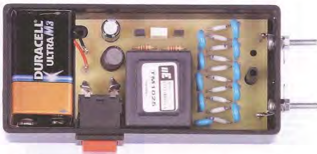
Fig.8 Ecco come si presenta il circuito del dissuasore elettronico LX.1775 una volta inserito all'interno del mobile. A sinistra potete notare la pila a 9 Volt inserita nel vano appositamente predisposto.
