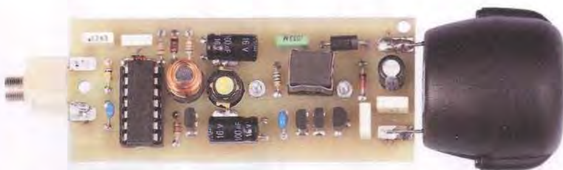
Fig.7 In questa foto è riprodotto il circuito della sirena a montaggio ultimato. Questo esemplare è stato utilizzato nel corso dei nostri test.
