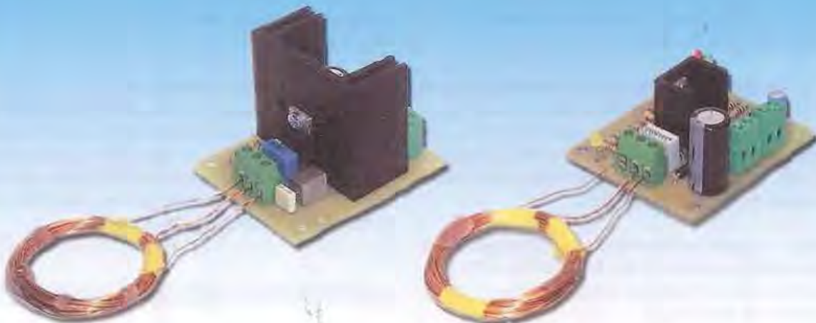
Fig.1 Ecco come si presentano a montaggio ultimato i circuiti del trasmettitore e del ricevitore che costituiscono il nostro caricabatteria.
