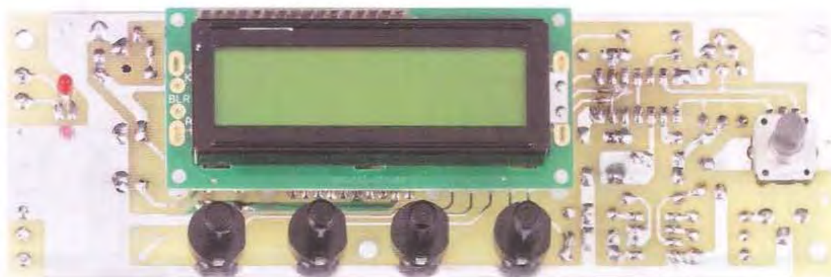
Fig.22 Ecco come si presenta il circuito stampato LX.1778 dopo aver fissato il display LCD e gli altri pochi componenti destinati a questo lato della scheda.
