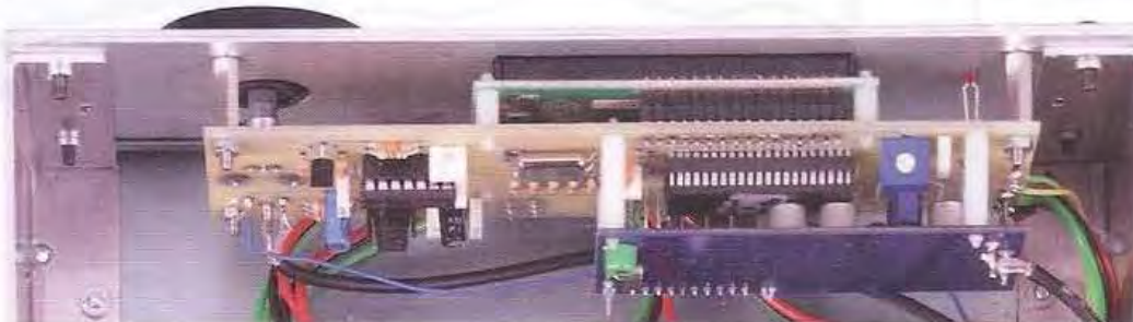
Fig.27 Particolare della mascherina frontale nella quale va innestato il blocco formato dalla scheda CPU, pulsanti, display e dalla scheda in SMD KM1644.
