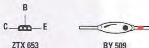
Fig.2 Connessioni del transistor ZTX653 viste da sotto e del diodo ad alta tensione BY509. Per individuare il terminale + di tale diodo vi rimandiamo alla fig.4.
