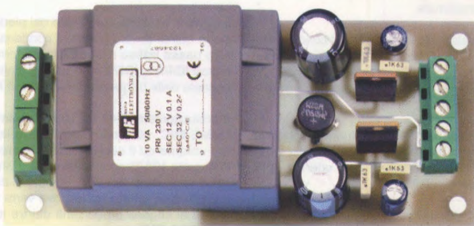
Fig.9 Ecco come si presenta l'alimentatore LX.1669 a montaggio concluso. Questo circuito andrà collocato sulla base del mobile e fissato tramite 4 clips adesive (vedi fig.28).
