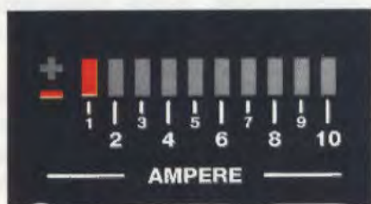
Fig.6 Se il tester misura 1 ampere e girate il trimmer R5 per accendere il led DL1, il led DL10 di fondo scala si accende quando la corrente è di 1 \times 10 = 10 ampere.
