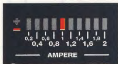
Fig.9 Se il tester misura 1 ampere e girate il trimmer R5 per accendere il led DL5, il led DL10 di fondo scala si accende quando la corrente è di 1 : 5 = 0,2 \times 10 = 2 ampere.
