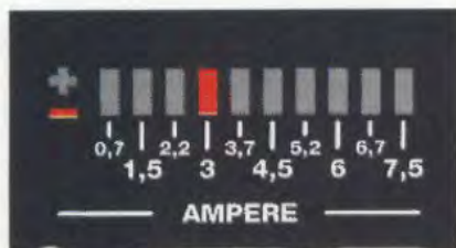
Fig.10 Se il tester misura 3 ampere e girate il trimmer R5 per accendere il led DL4, gli altri led si accendono con salti di 0,75 ampere ed il fondo scala è di 7,5 ampere.
