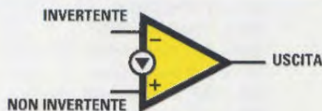
Fig.1 La riproduzione grafica di un amplificatore operazionale tipo Norton si contraddistingue per la presenza tra i due ingressi -/+ del simbolo di un "triangolo" con la punta rivolta verso il terminale positivo +.
