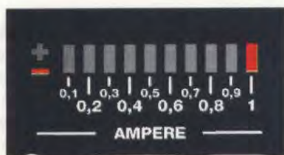
Fig.7 Se il tester misura 1 ampere e girate il trimmer R5 per accendere il led DL10 di fondo scala, il led DL1 si accende quando la corrente è di 1 : 10 = 0,1 ampere.
