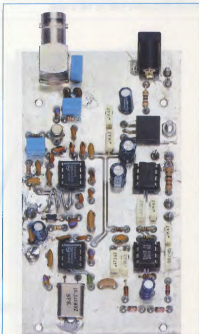
Fig.9 Foto del circuito stampato LX.1662 con sopra già montati tutti i suoi componenti. Sulla destra potete osservare il disegno pratico di questo montaggio.
