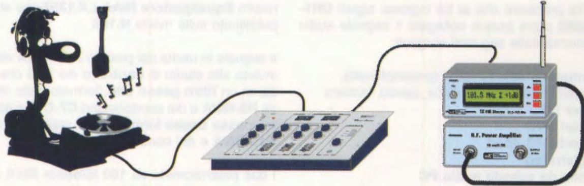
Fig.4 Con il mixer potrete sfruttare al meglio le vostre doti di intrattenimento perché, abbinandolo al nostro Eccitatore KM.1619 da 88-108 MHz e all'amplificatore Lineare LX.1636, sarete in grado di costruirvi, previo conseguimento delle necessarie autorizzazioni, una piccola radio privata.
