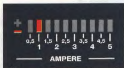
Fig.8 Se il tester misura 1 ampere e girate il trimmer R5 per accendere il led DL2, il led DL10 di fondo scala si accende quando la corrente è di 1 : 2 = 0,5 \times 10 = 5 ampere.
