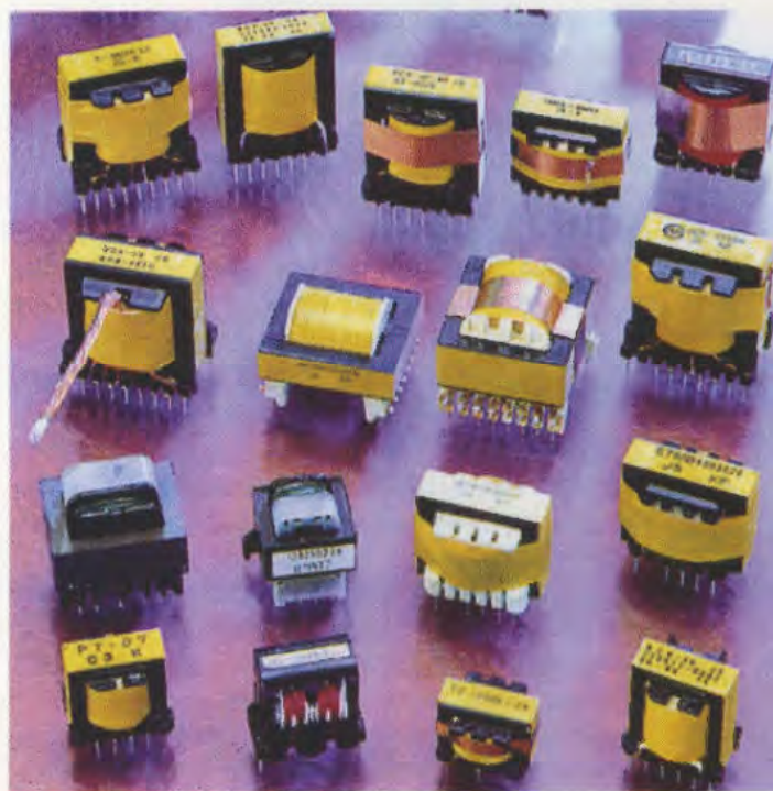
Fig.1 I trasformatori, anche se di forma e dimensioni diverse tra loro, si calcolano sempre conoscendo l'Impedenza di Carico della valvola a cui sono collegati e la loro potenza d'uscita in Watt, come spieghiamo dettagliatamente in questo articolo.
