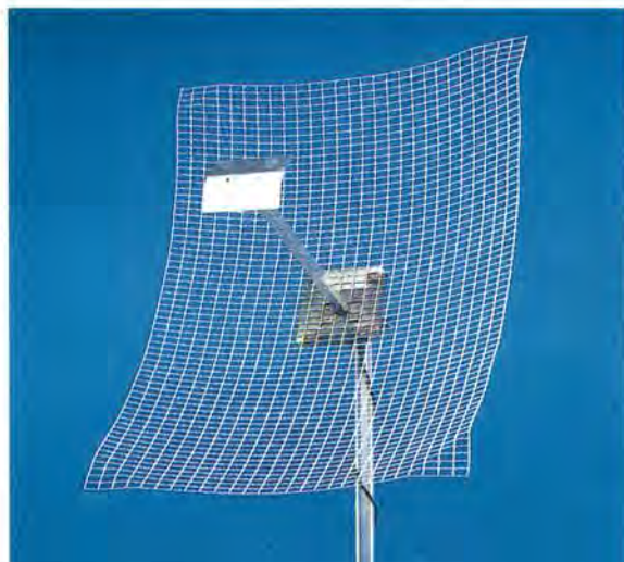
Fig.2 Per ricevere il segnali del Meteosat è sufficiente una parabola circolare del diametro di 90 cm oppure una parabola a Griglia delle dimensioni di 76 x 97 cm.
