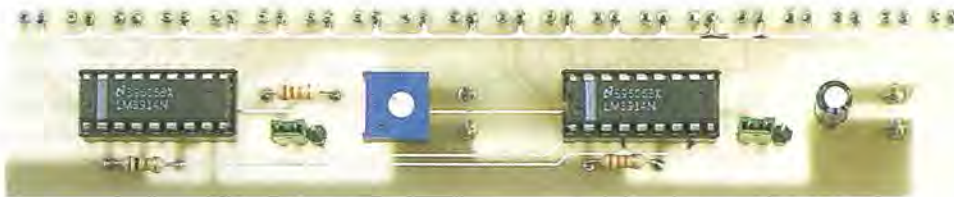
Fig.16 Foto del montaggio del voltmetro con due integrati LM.3914. I diodi led andranno inseriti dal lato opposto del circuito stampato come visibile in fig.27.
