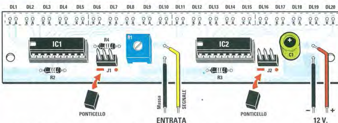
Fig.28 Per realizzare lo schema elettrico di fig.15, che utilizza due integrati LM.3914 per poter accendere un totale di 20 diodi led, dovete montare i pochi componenti richiesti sul circuito stampato siglato LX.1440.
