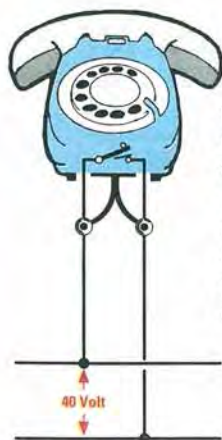
Fig.1 Sulla linea telefonica è presente una tensione di 40 volt, che rimane su questo valore per tutto il tempo in cui la cornetta dell'apparecchio viene mantenuta abbassata.
