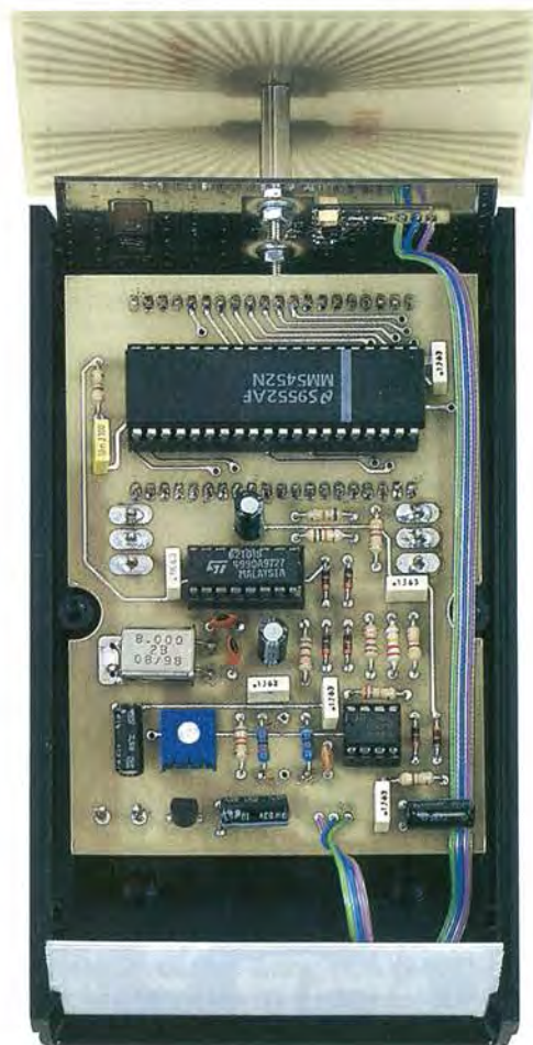
Fig.10 Il circuito stampato va bloccato all'interno del mobile con i dadi dei deviatori a levetta S1-S2. Se il modulo IC1 dovesse muoversi, potete fissarlo nella scanalatura con una goccia di collante.
