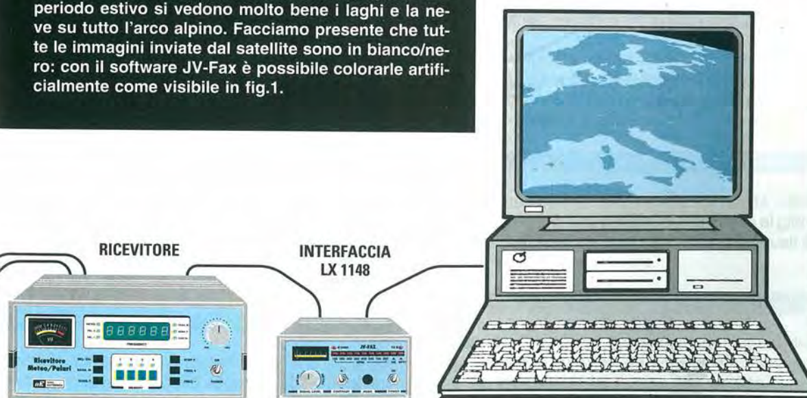
Fig.4 Il segnale prelevato dal Convertitore collegato alla parabola a Griglia viene inserito nel Ricevitore e applicato tramite un'Interfaccia ad un Computer provvisto di un sistema operativo MS-DOS. Se, oltre al Meteosat, si desiderano ricevere anche i satelliti Meteo Polari, occorre una antenna supplementare a doppio V completa di preamplificatore.
