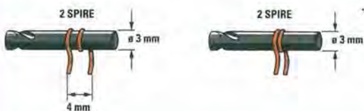
Fig.13 Per le bobine L1-L2-L6-L7 avvolgete su un diametro da 3 mm 2 sole spire. Le bobine L1-L2 andranno spaziate fino ad ottenere un solenoide lungo 4 mm, mentre le 2 spire delle bobine L6-L7 dovranno risultare unite.
