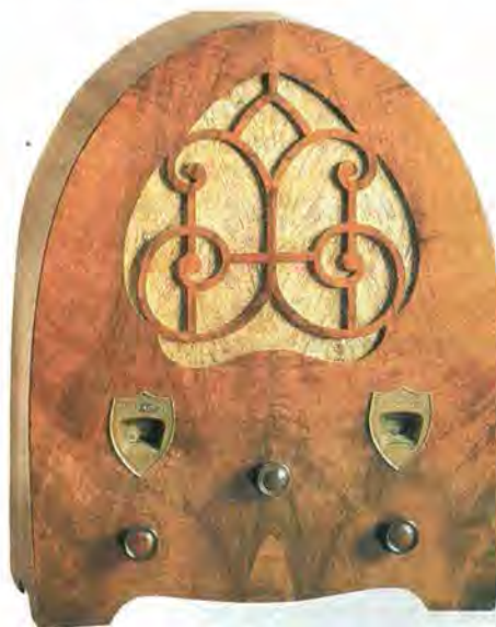
Fig.364 Negli anni 1928-1930 apparvero i primi ricevitori supereterodina. Il mobile, sempre in legno, venne reso più elegante e la tromba venne sostituita da un altoparlante per migliorare la qualità sonora.
