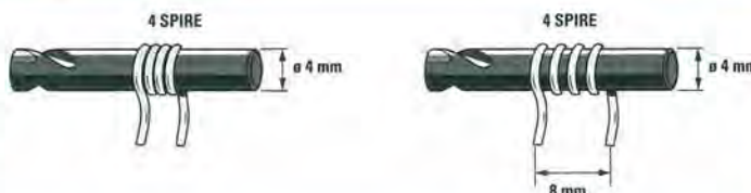
Fig.14 Per le bobine L3-L4-L5 avvolgete su un diametro da 4 mm 4 spire. Queste spire andranno spaziate fino ad ottenere un solenoide lungo 8 mm.
