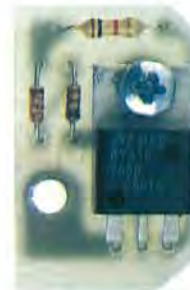
Fig.3 Collegando in serie ad ogni telefono il circuito da noi progettato, chi solleva per primo la cornetta automaticamente scollegherà il secondo apparecchio. Sopra, le connessioni del diodo Triac e la foto del piccolo circuito da montare sulla spina di attacco di ciascun telefono (vedi fig.7).
