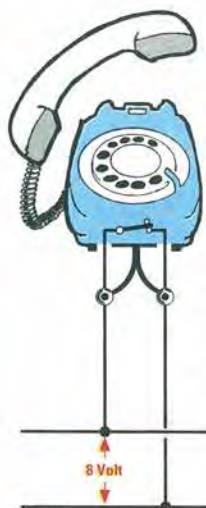
Fig.2 Quando la cornetta viene sollevata, la tensione di 40 volt presente sulla linea si chiude su un carico di 600 ohm e, automaticamente, la tensione scende sugli 8 volt.
