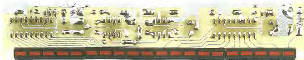
Fig.31 Foto del VU-Meter LX.1442 visto dal lato delle barre dei diodi led.
