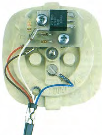
Fig.7 Foto del circuito stampato già fissato sulla spina telefonica. Se il coperchio della spina non dovesse chiudersi, sarà sufficiente arrotondare con una lima i due spigoli superiori del circuito stampato.
