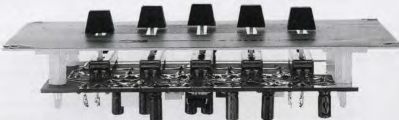
Fig.3 Per fissare il circuito stampato sul pannello del mobile dovrete utilizzare i quattro distanziatori plastici con base autoadesiva forniti assieme al kit LX.1356.
