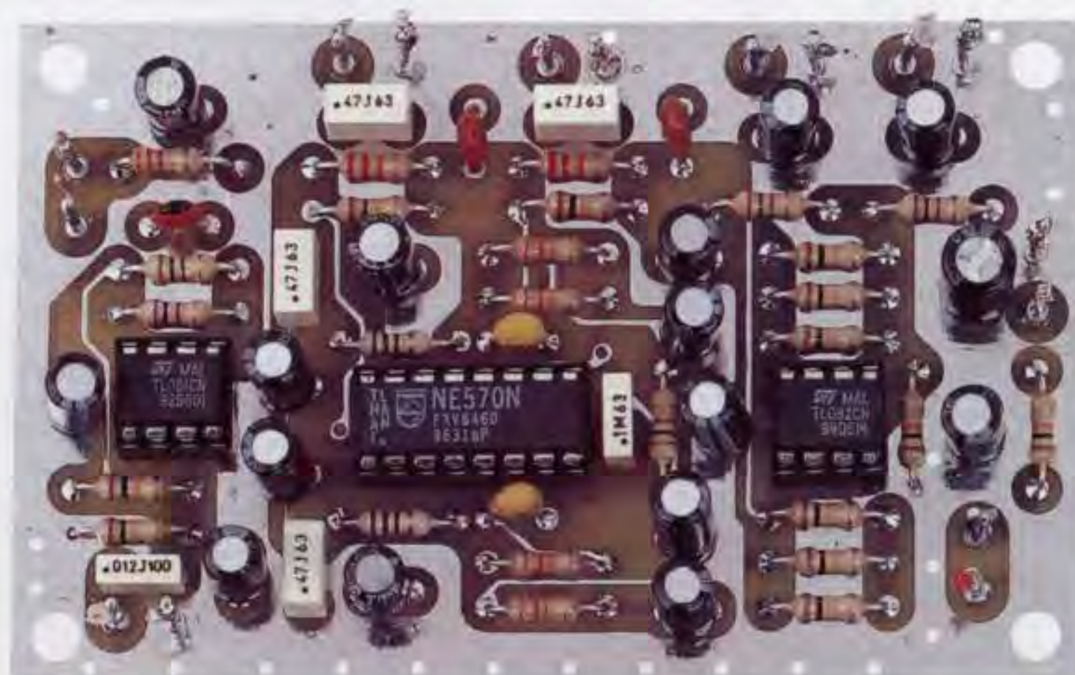
Fig.2 Come si presenta la basetta del circuito stampato LX.1363 dopo che sono stati montati tutti i componenti (vedi schema pratico in fig.6).
