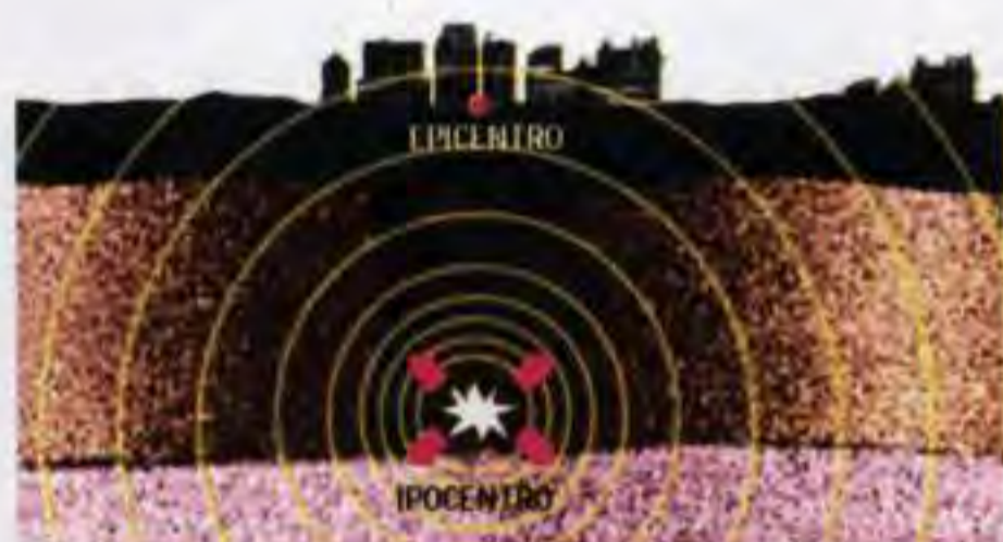
Fig.6 Se una faglia incontra uno strato rigido, lo comprime fino a quando non riesce a spezzarlo. Quando questo avviene viene liberata tutta l'energia accumulata nella compressione e la crosta terrestre inizia a vibrare in un raggio di diversi chilometri facendo crollare gli edifici.
