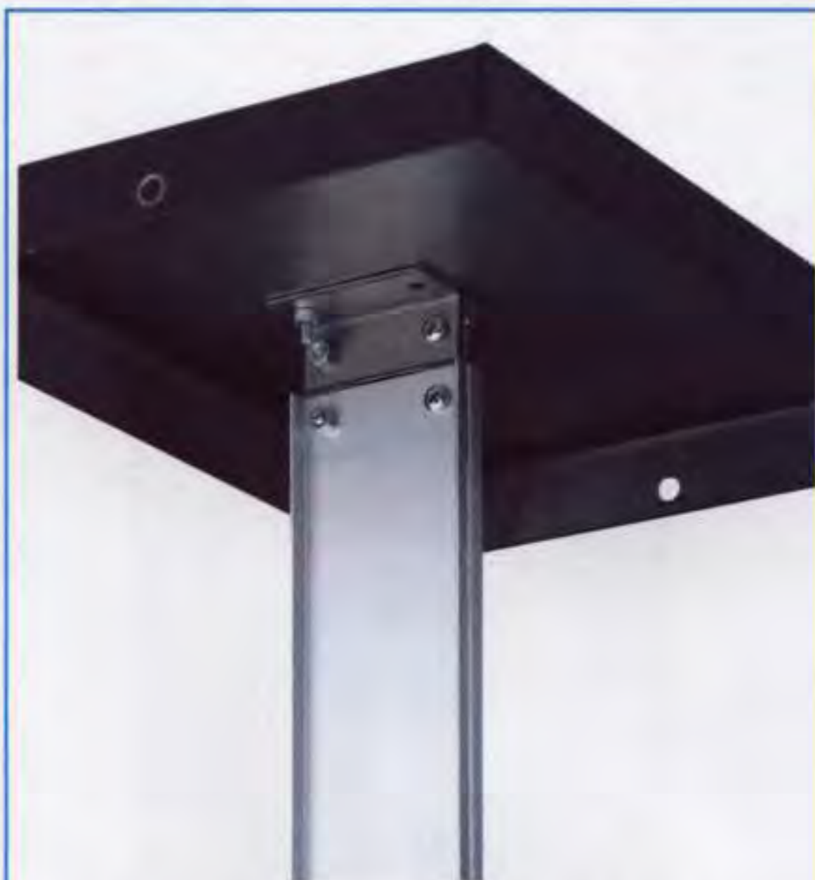
Fig.3 Dopo aver fissato tra le due aste verticali le lamelle di acciaio da 0,06 mm, stringete le opposte estremità nelle due squadrette a L (vedi disegno a destra), quindi fissate il pendolo al coperchio.
