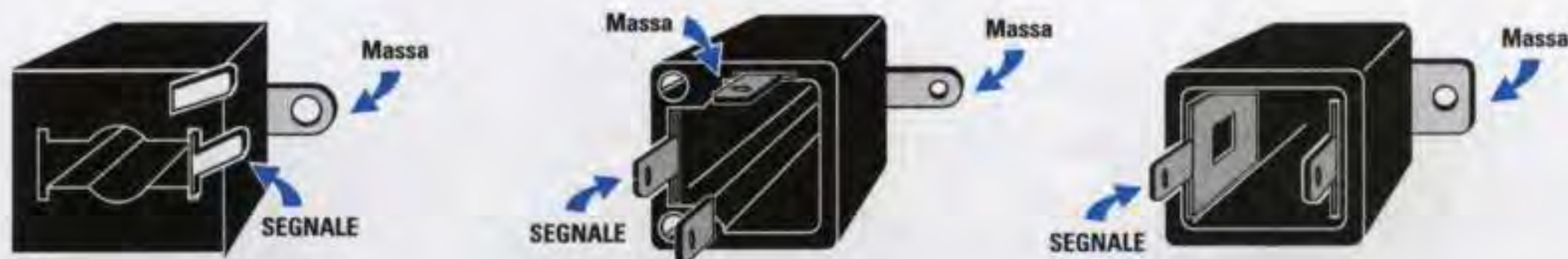
Fig.7 Poiché sulle prese femmina dei microfoni potete trovare più terminali, in questo disegno vi indichiamo quali sono quello del Segnale e quello di Massa. Il terzo terminale presente in queste prese viene utilizzato come interruttore per cortocircuitare a massa l'ingresso quando viene sfilato lo spinotto Jack dalla presa.
