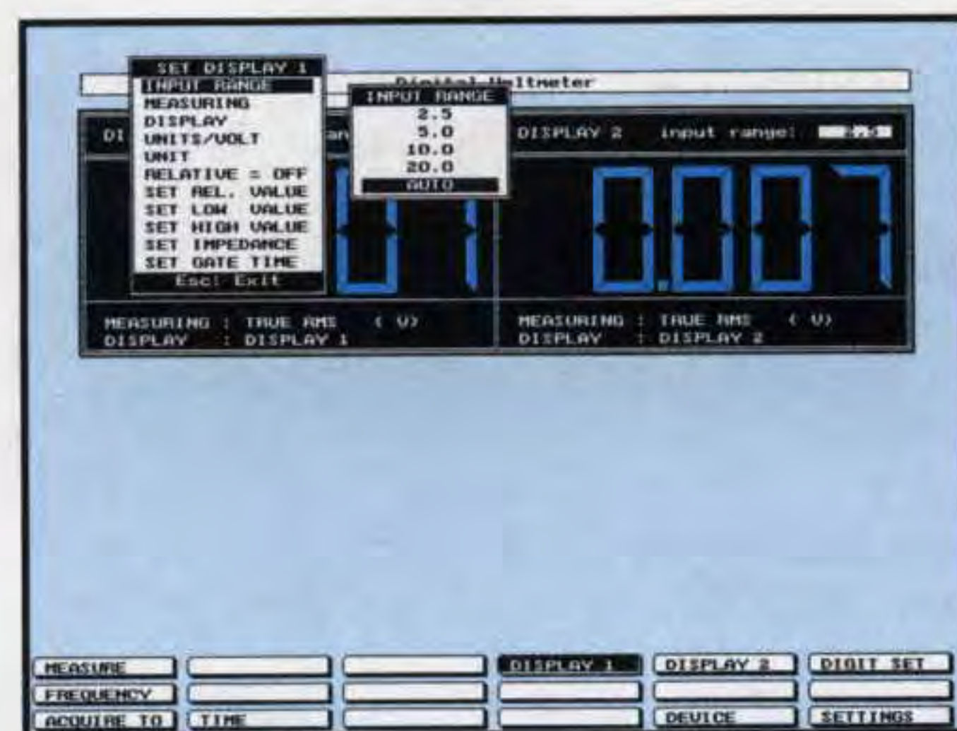
Fig.14 Se portate il cursore su Display 1 e pigiate Enter potrete scegliere un valore di fondo scala. Se andrete su AUTO la portata verrà scelta in modo automatico.
