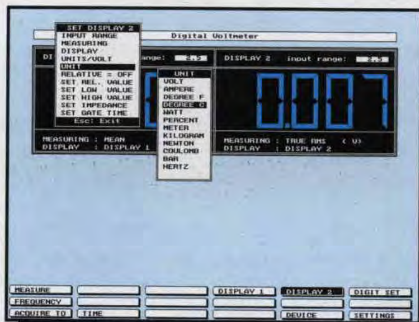
Fig.35 Dopodiché settate il Display 2 andando sulla riga UNIT poi pigiando Enter e nella finestra che appare andate sulla riga DEGREE C e pigiate Enter.
