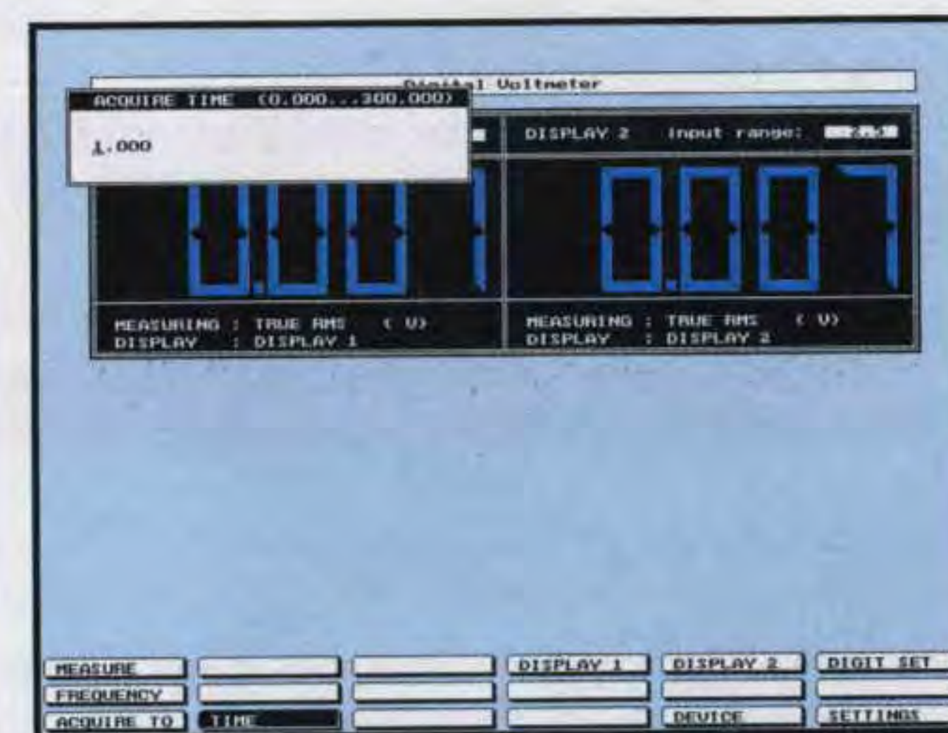
Fig.33 Se portate il cursore su Time poi pigiate Enter potrete cambiare il tempo dei dati di acquisizione da 0,5 secondi fino ad un massimo di 300 secondi.
