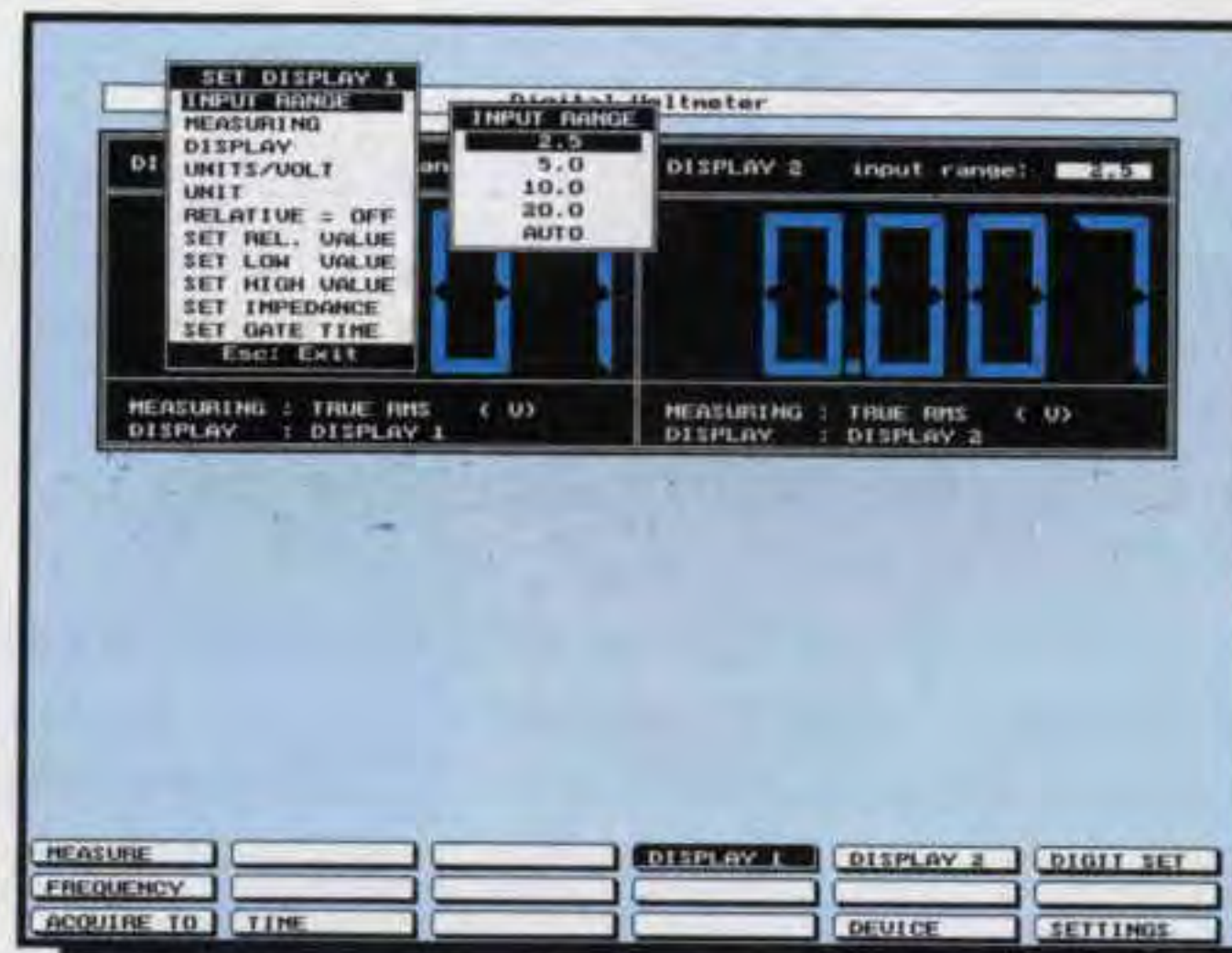
Fig.34 Per misurare un valore di temperatura occorre una sonda. Se la massima tensione che fornisce la sonda non supera i 2 volt scegliete 2,5 volt.
