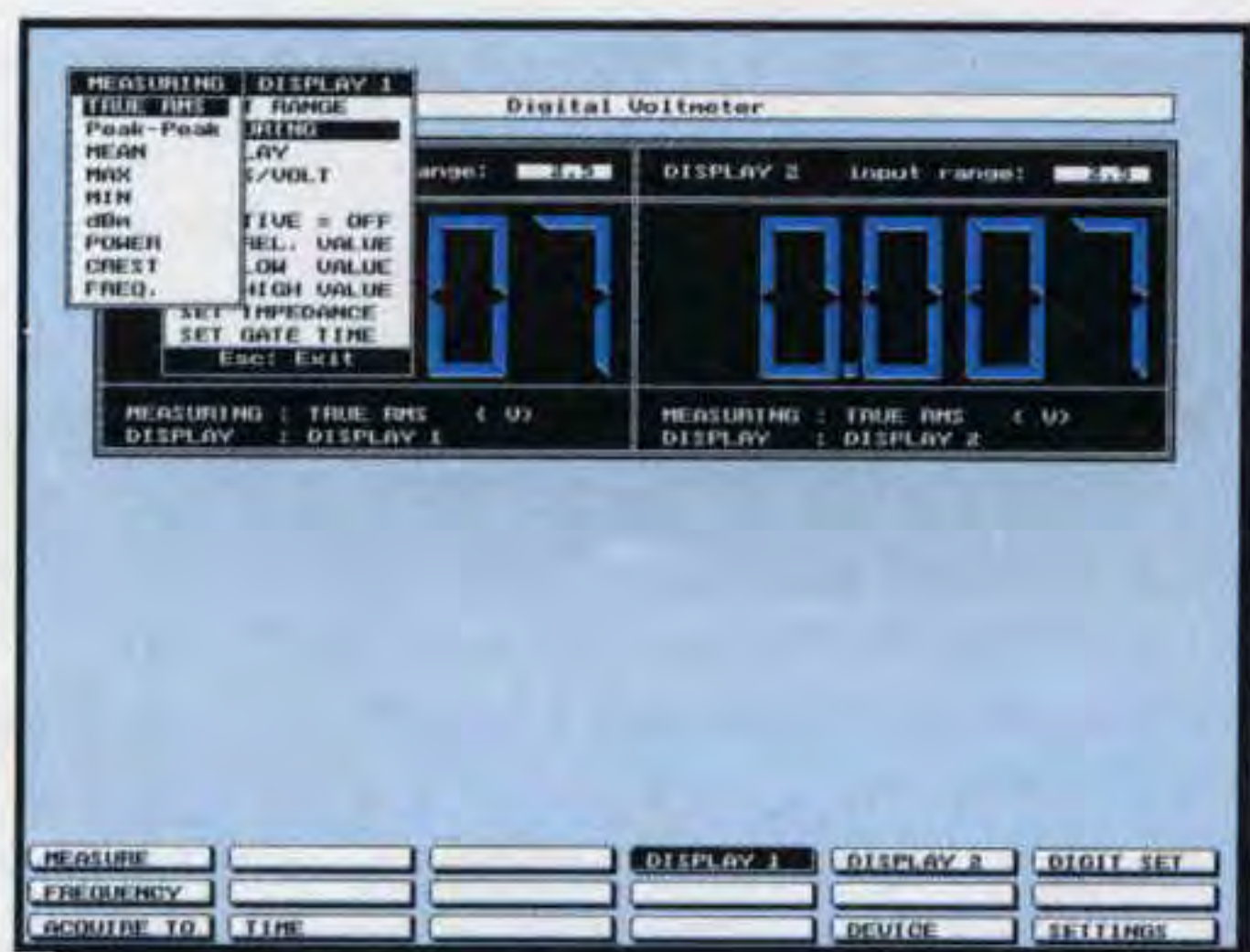
Fig.18 Per le misure di tensione in AC dovrete andare su Measuring e nella finestra che appare dovrete andare sulla riga TRUE RMS per leggere i volt Efficaci.
