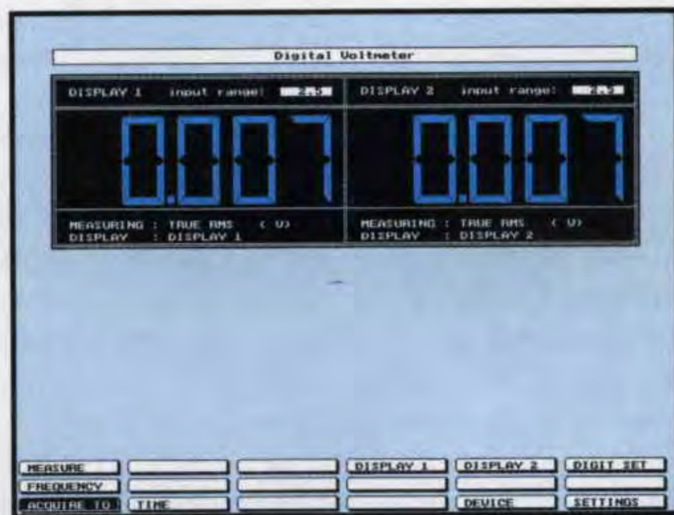
Fig.13 Sullo schermo vedrete apparire un doppio tester. Se l'ultima cifra a destra non indica 0 non preoccupatevi perché le misure che farete risulteranno precise.
