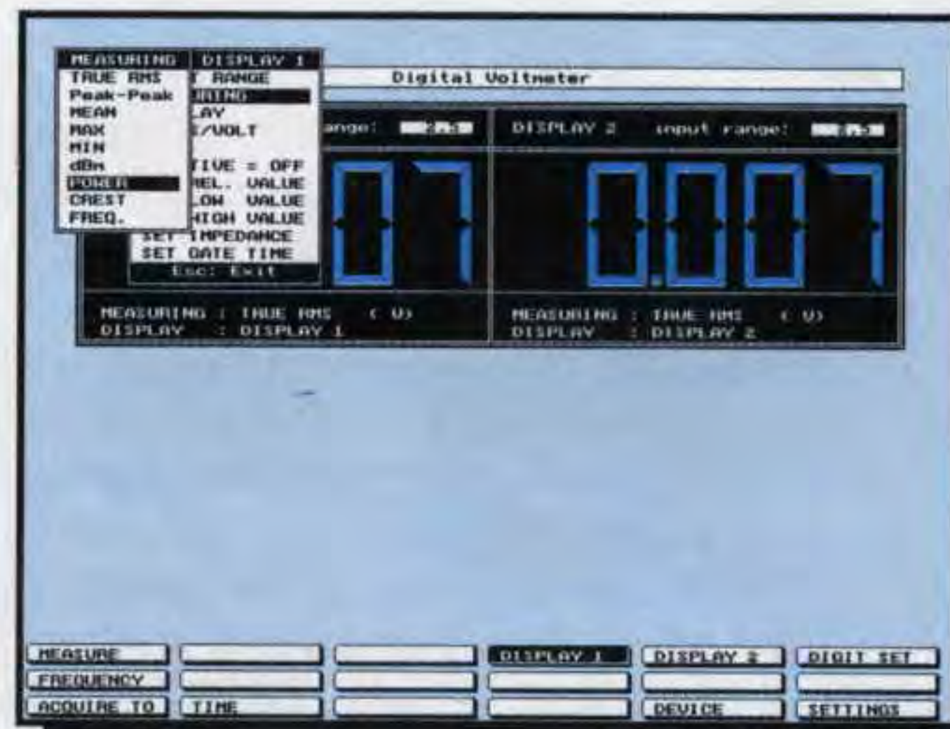
Fig.22 Se volete leggere a quanti watt corrisponde una tensione applicata ad un carico, dovete andare sulla riga Power poi pigiare il tasto Enter.
