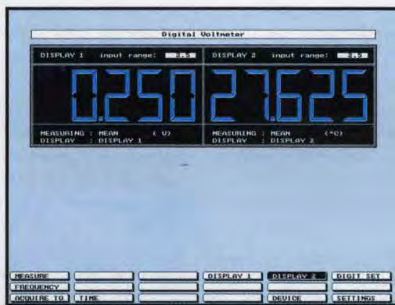
Fig.37 Pigiando Enter in fig.7 visualizzate sul Display 1 la tensione fornita dalla sonda e sul Display 2 il corrispondente valore in GRADI centigradi.
