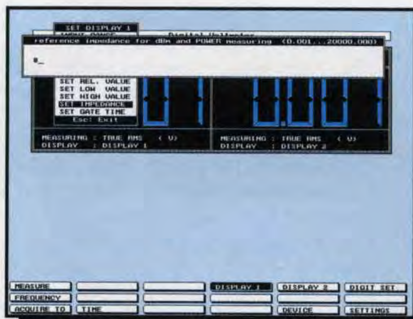
Fig.23 Andate quindi sulla riga Set Impedance poi pigiate Enter e nella finestra che appare scrivete il valore della impedenza di carico 4 - 8 - 32 ecc.
