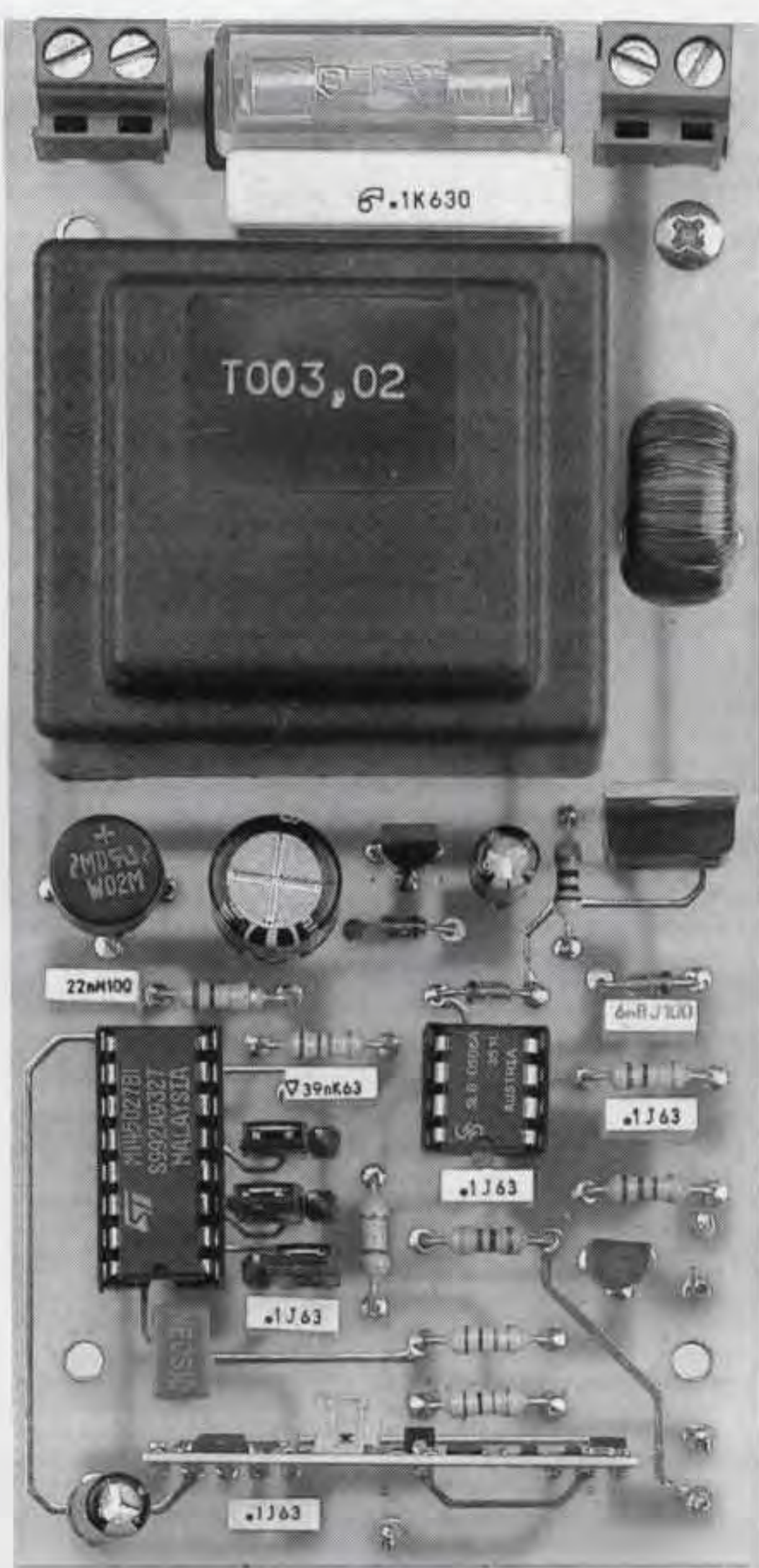
Fig.8 Foto di come si presenta la scheda del ricevitore a montaggio ultimato. In basso si riesce a vedere il sottile modulo SMD montato in posizione verticale.
