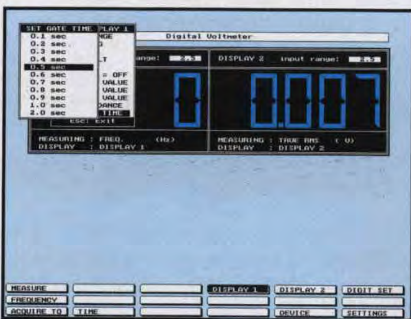
Fig.29 Quando predisponete l'interfaccia sulla funzione frequenzimetro dovete andare su Set Gate Time e scegliere un valore di 0.5 - 0.6 - 0.7 secondi.
