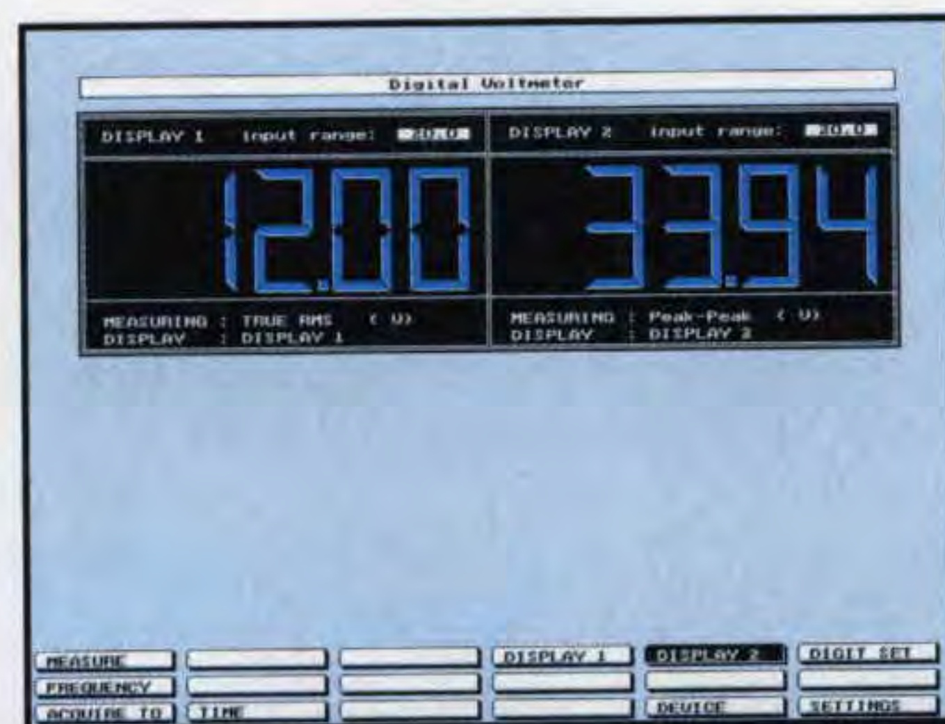
Fig.21 Poiché abbiamo sul monitor due tester, potrete predisporre il primo per leggere i volt RMS ed il secondo per i volt Picco/Picco (leggere l'articolo).
