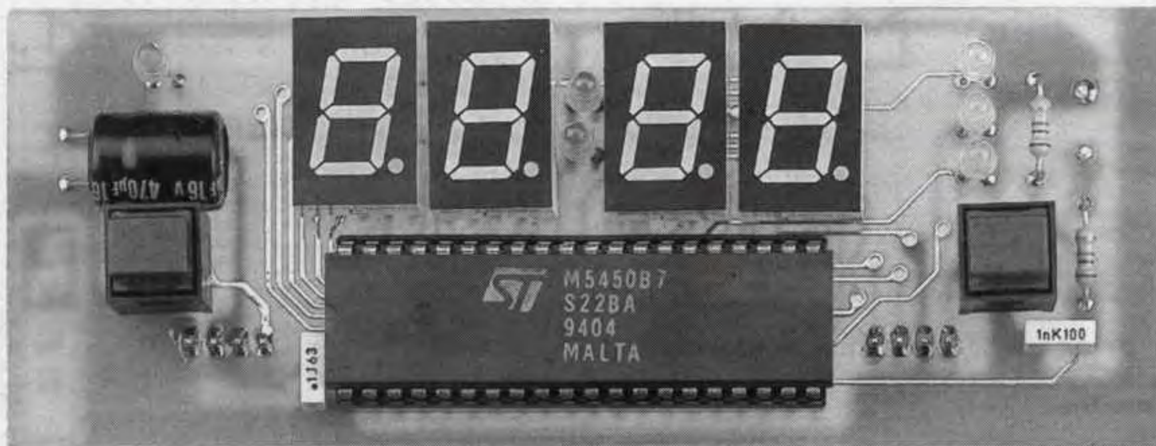
Fig.8 Sul lato frontale dello stampato LX.1280/B andranno fissati i quattro Display, tutti i diodi led, i due pulsanti P1 - P2 e l'integrato M.5450 (vedi fig.6). Quando inizierete a montare questa scheda seguite attentamente le istruzioni riportate nell'articolo.
