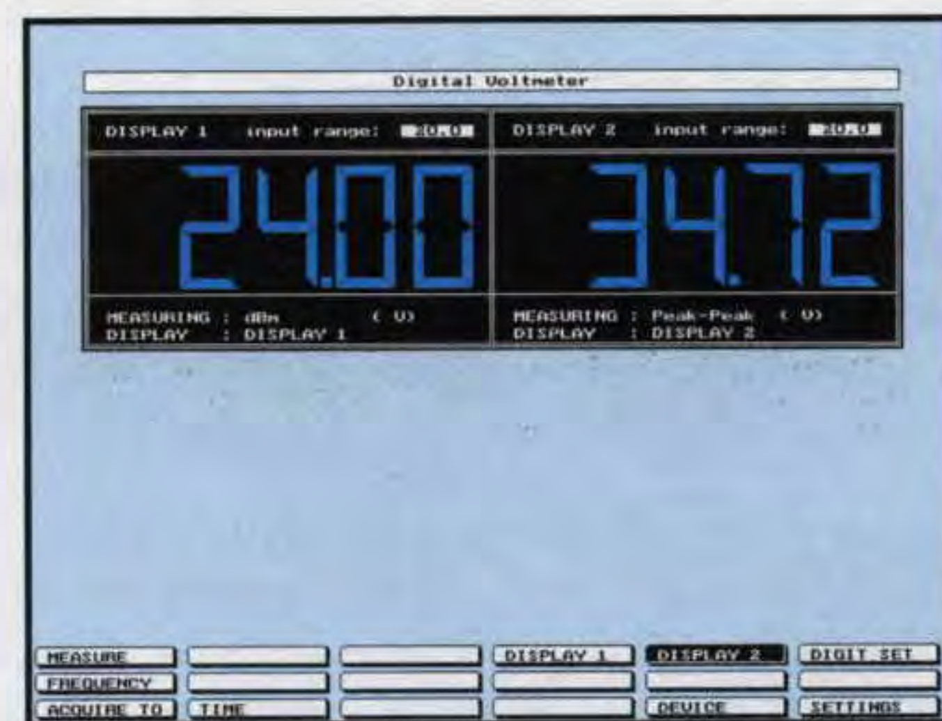
Fig.27 Sul primo display appare scritto il valore in dBm e sul secondo display il valore della tensione RMS oppure, se preferite, in volt Peak-Peak.
