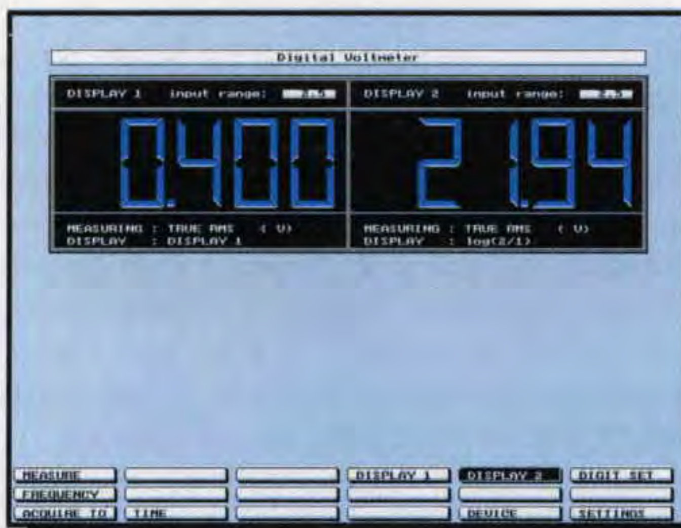
Fig.42 Sul primo display appariranno i volt d'ingresso e sul secondo il Guadagno in dB. Potete usare questa funzione anche per calcolare una Attenuazione.
