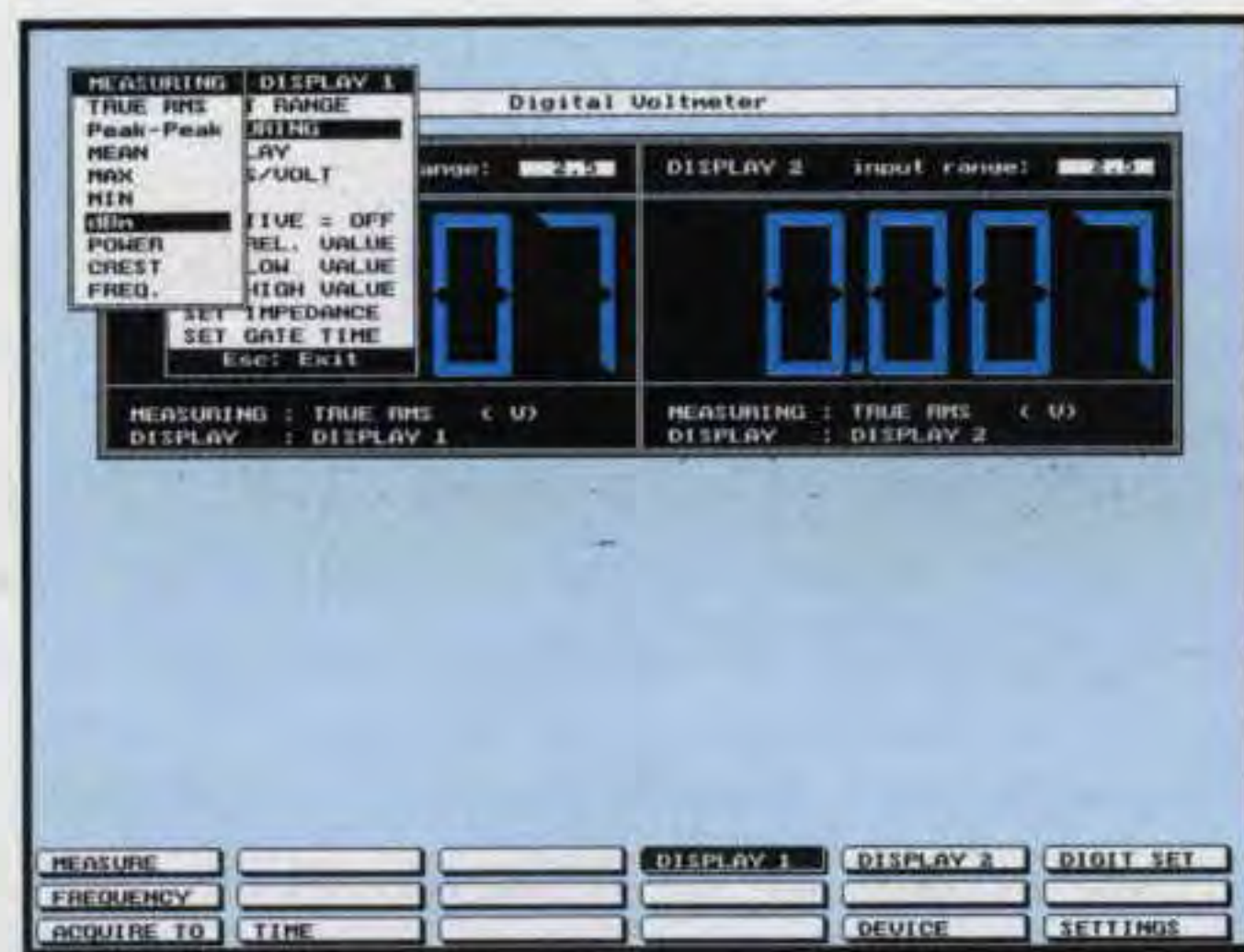
Fig.25 Se volete conoscere la potenza espressa in dBm dovreste portare il cursore su questa riga poi pigiare Enter, poi andare sulla riga Set Impedance e Enter.
