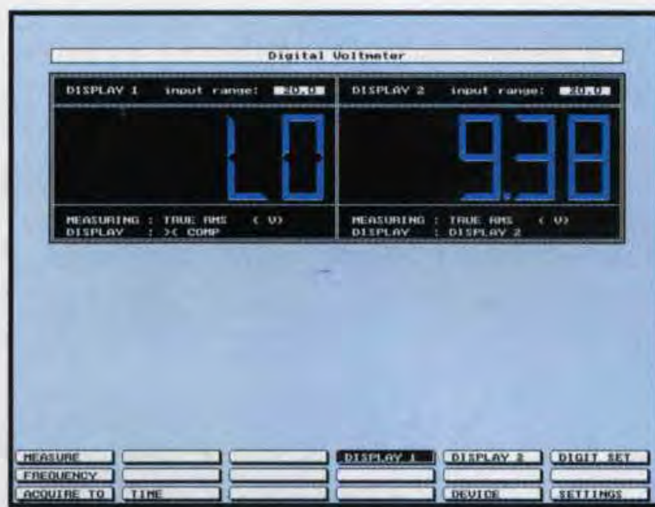
Fig.40 Se nel SET VALUE avete inserito un valore di minima e di massima, sul Display 1 vedrete apparire HIGH se è maggiore, LO se minore oppure PASS.
