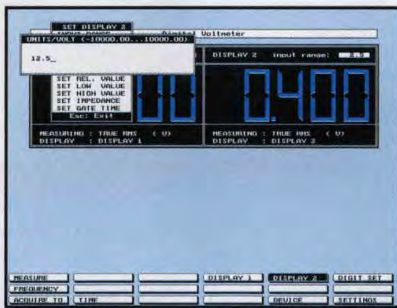
Fig.41 Per calcolare il Guadagno in dB dovette portare il cursore su LOG (2/1) ed inserire nella finestra il valore dei volt di uscita divisi i volt d'ingresso.
