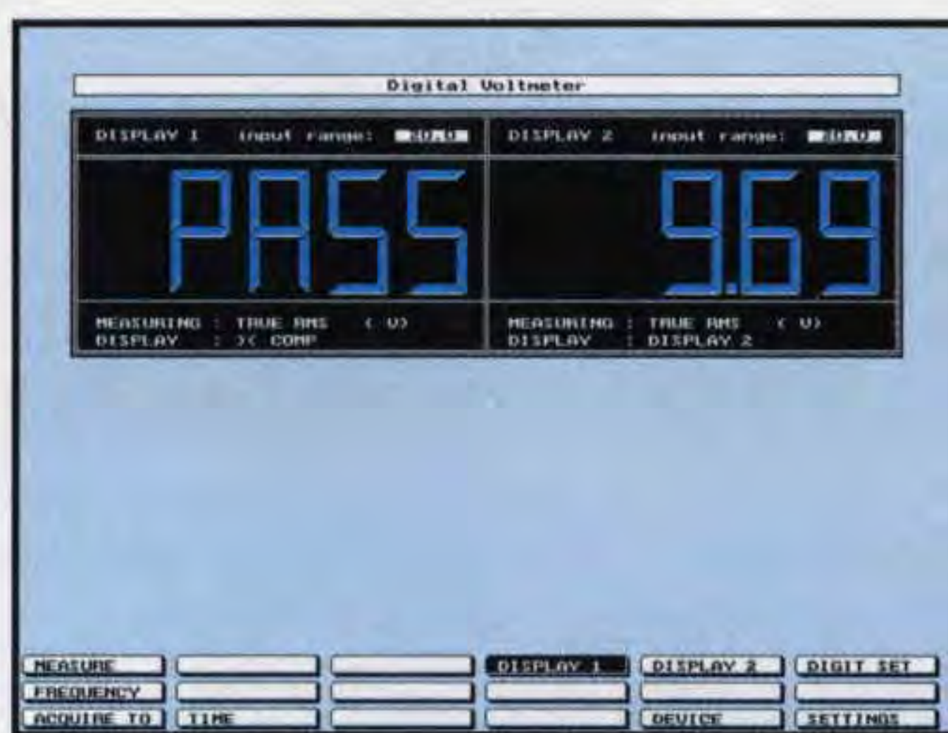
Fig.39 La finestra di fig.38 vi permette di fare una comparazione inserendo in SET LOW VALUE e in SET HIGH VALUE due diversi valori di tensione o di frequenza.
