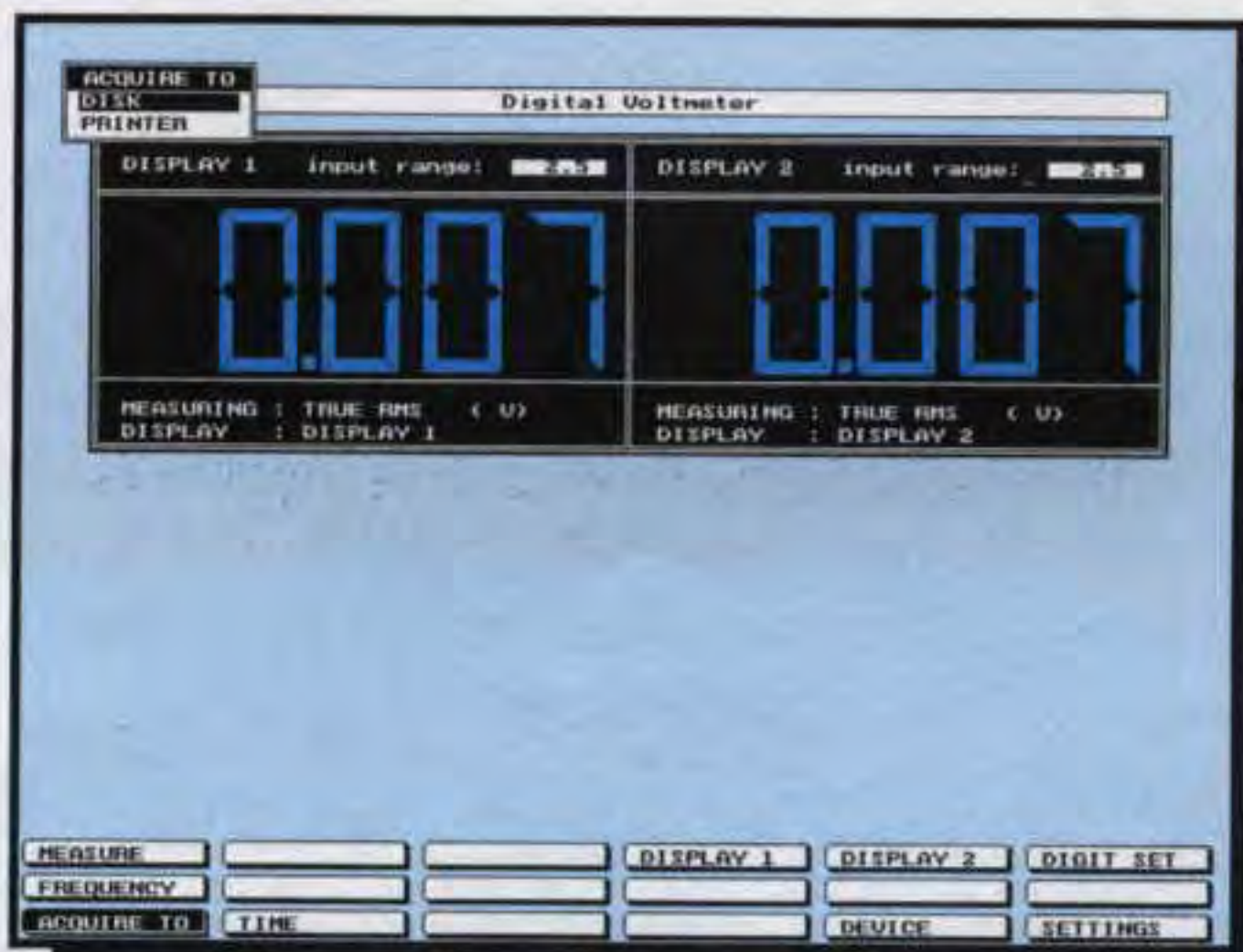
Fig.30 Se andate sulla finestra con la scritta Acquire To poi sulla riga Disk potrete memorizzare tutte le variazioni di tensione o frequenza per poi stamparle.
