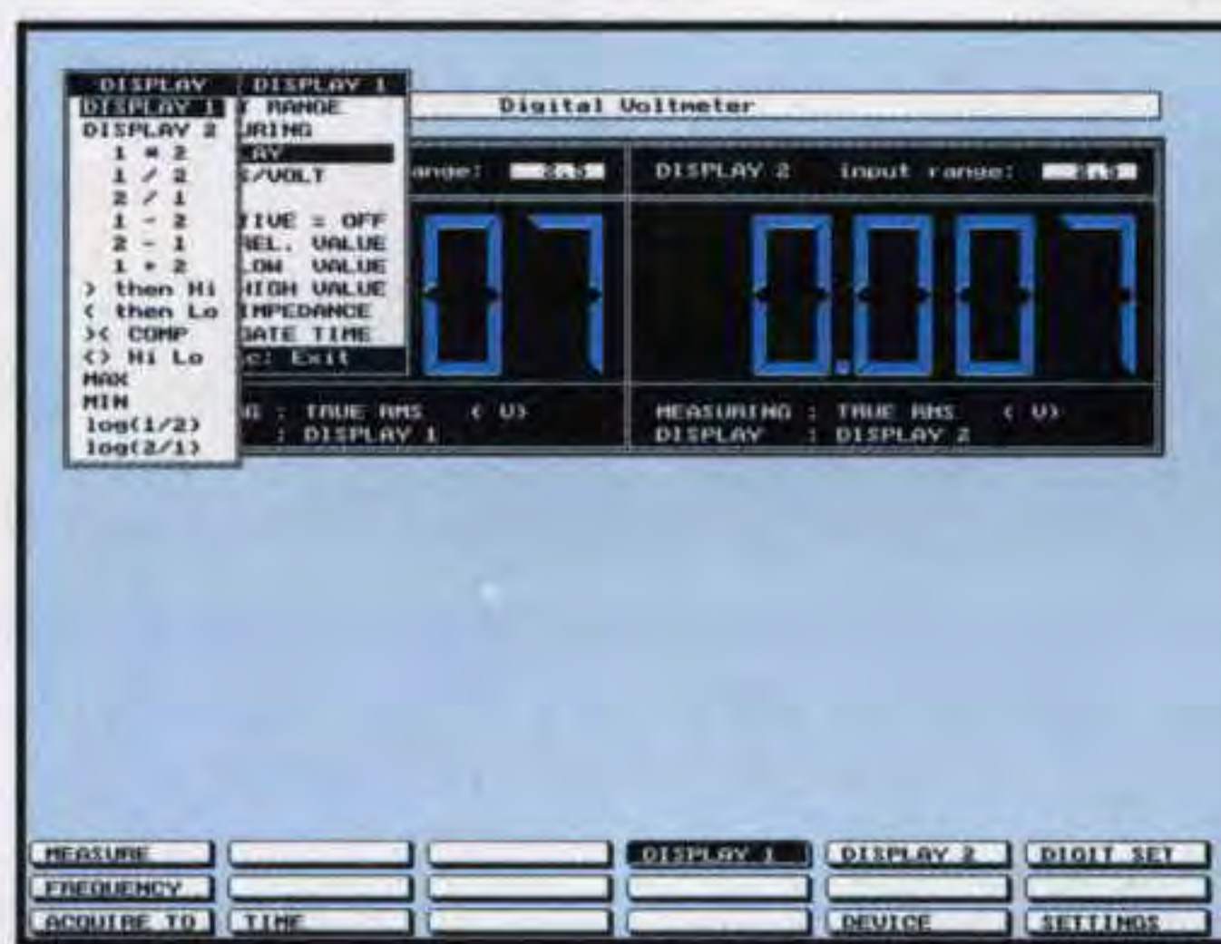
Fig.38 Se nella finestra Set Display 1 portate il cursore sulla riga Display e pigiate Enter appare un'altra finestra che vi permette di fare altre misure.
