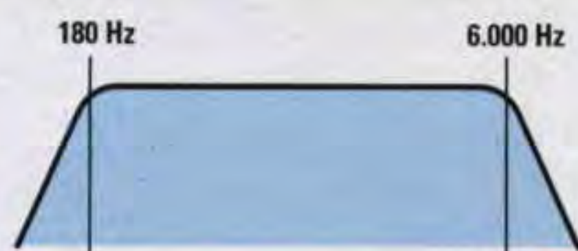
Fig.1 Ruotando la manopola del potenziometro R23 a metà corsa amplifichiamo tutta la banda audio da 180 Hz fino a 6.000 Hz, cioè tutte le frequenze dei Bassi e degli Acuti.
