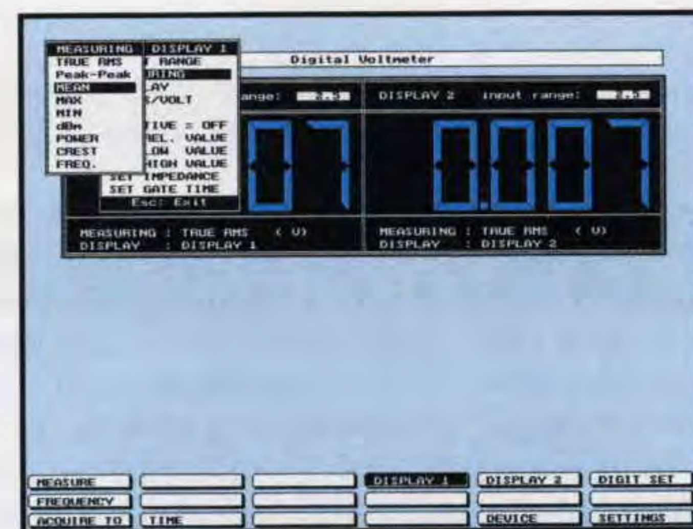
Fig.15 Per le misure di tensione in CC dovete andare su Measuring pigiare Enter e nella finestra che appare dovete portare il cursore su MEAN poi pigiare Enter.
