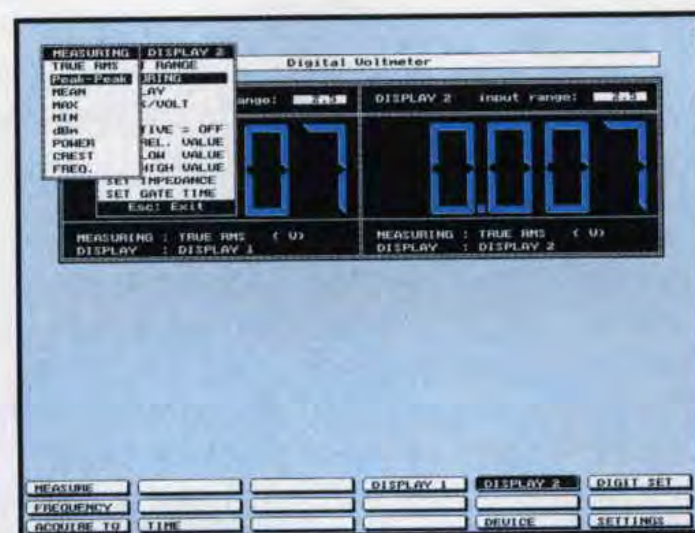
Fig.20 Se di una tensione AC volete conoscere il valore dei volt picco/picco dovete portare il cursore sulla riga Peak-Peak poi pigiare Enter.
