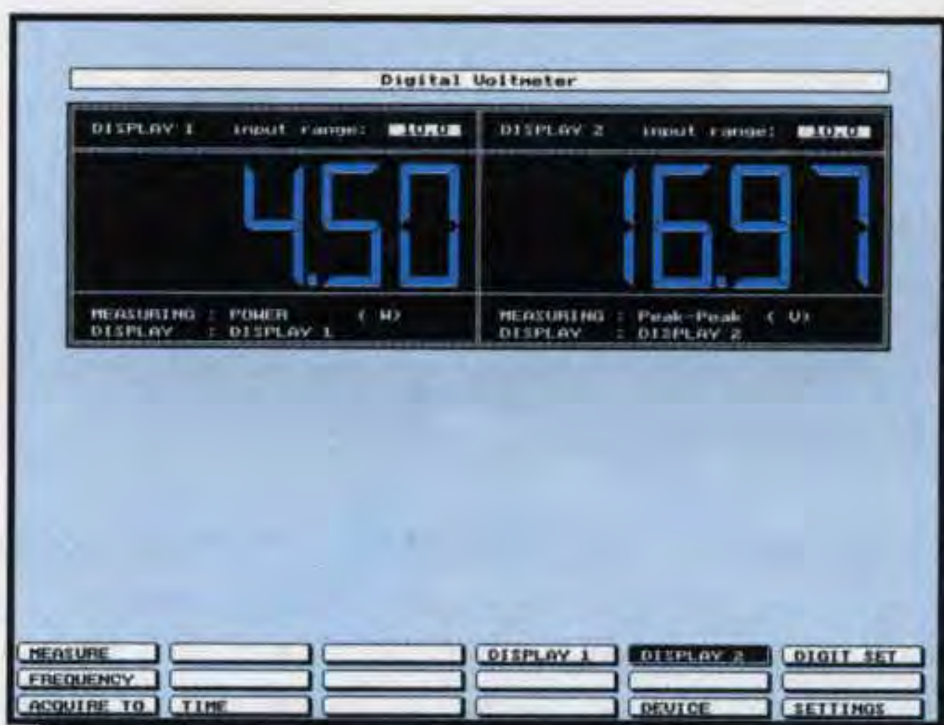
Fig.24 Dopo aver pigiato Enter ed Escape sul primo display apparirà il valore della potenza in watt e sul secondo display il valore dei volt della tensione alternata.
