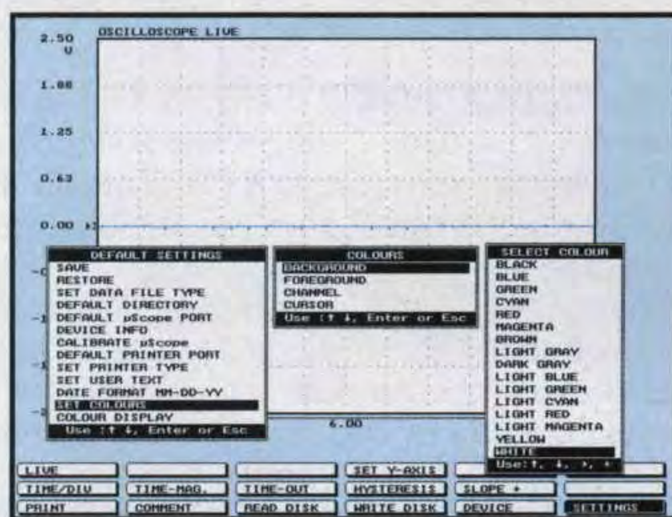
Fig.6 Se portate il cursore sulla riga Set Colours e premete Enter, appaiono due finestre che potrete usare per modificare i colori delle tracce o dello schermo.
