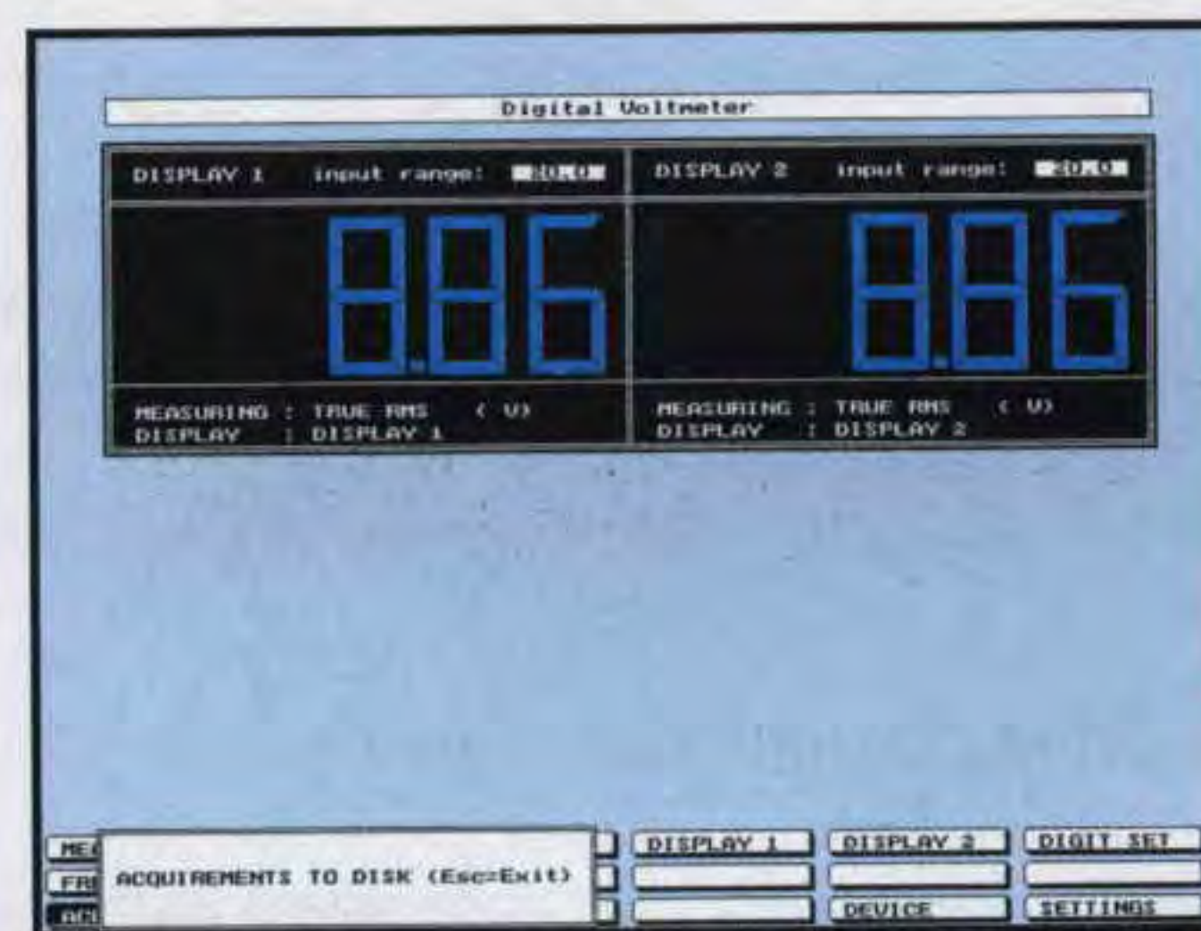
Fig.32 Dopo aver sostituito Data-1 (vedi fig.31) con un nome pigiate Enter e subito inizierà la memorizzazione. Per bloccare questa funzione pigiate Escape.
