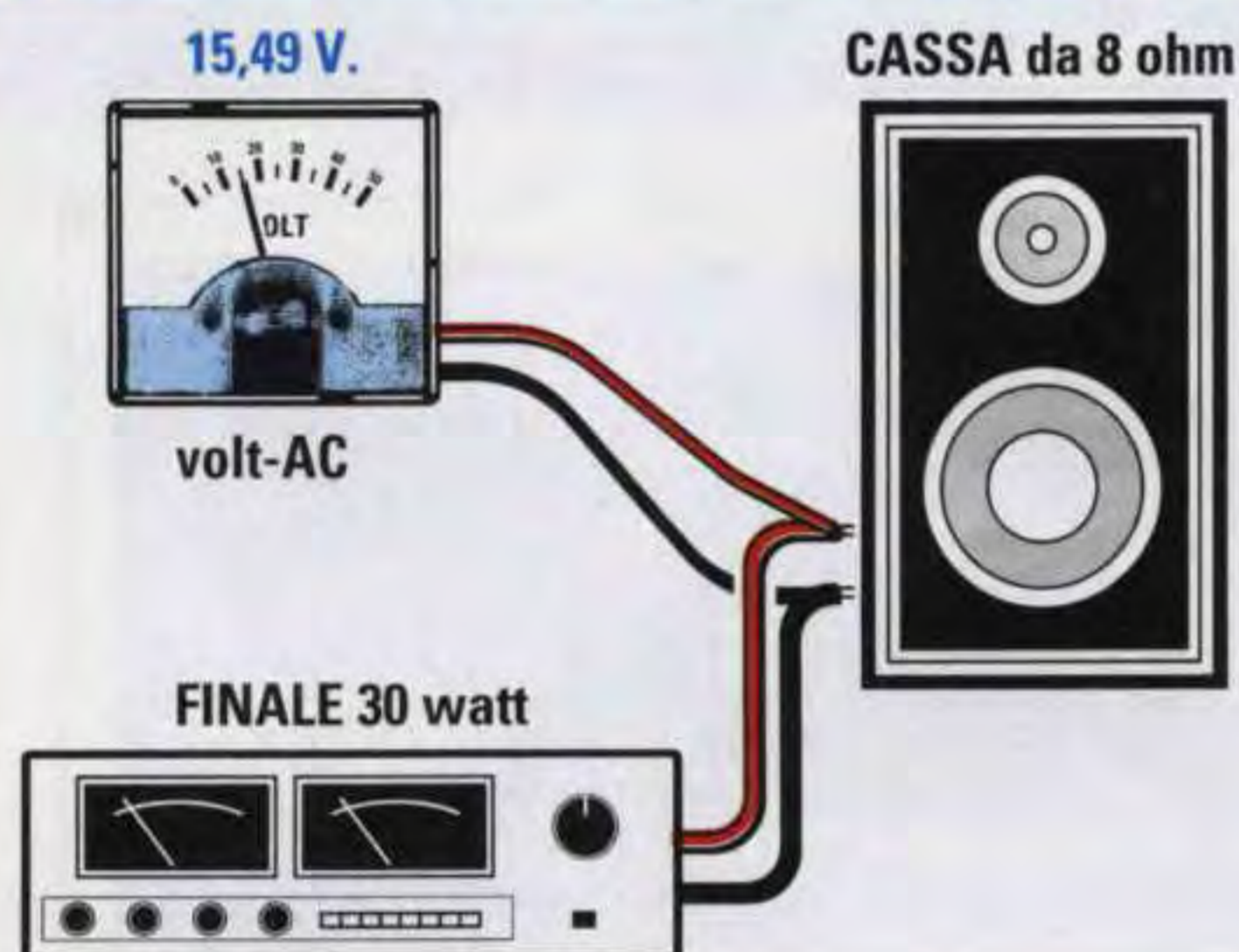
Fig.249 – Tensione efficace sull'ingresso di una Cassa Acustica
