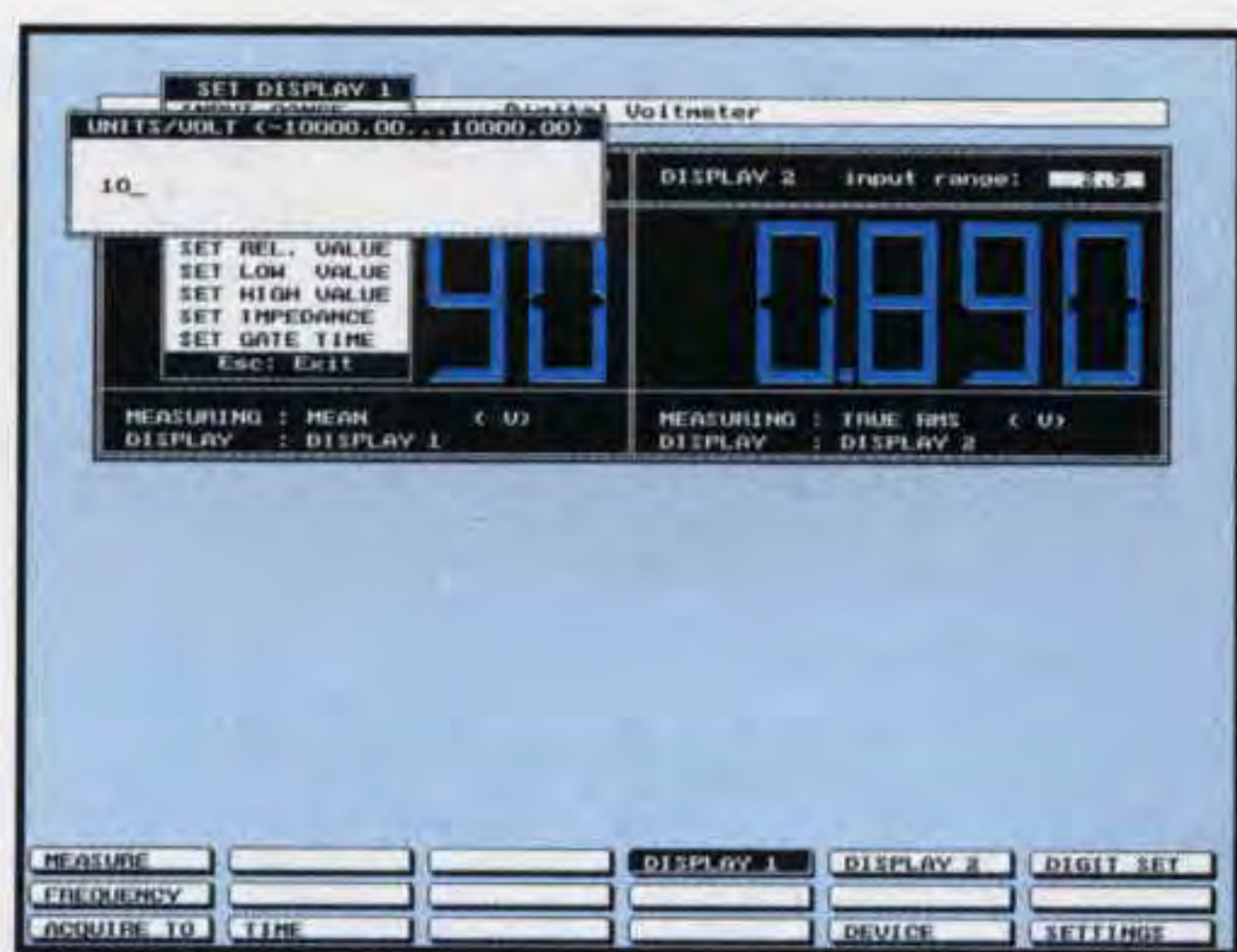
Fig.17 Se usate il puntale con una attenuazione di 10 e desiderate leggere la reale tensione sull'ingresso del puntale dovrete scrivere 10 in questa finestra.
