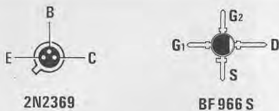
Fig.2 Connessioni del 2N2369 visto da sotto e del BF966/S visto da sopra. Il terminale D del mosfet si riconosce dalla mezzaluna stampigliata sul suo corpo.
