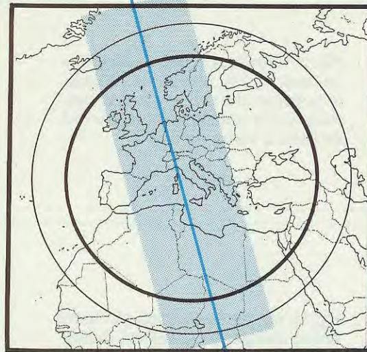
Fig. 16 Poiché l'orbita di ogni satellite risulta inclinata rispetto ai due punti cardinali Nord-Sud, con le orbite ascendenti il satellite giungerà da Sud/Est per proseguire verso Nord/Ovest, quindi sullo schermo vedremo ad esempio prima l'Egitto e la Libia, poi il sud dell'Italia quindi il nord e, proseguendo, l'Inghilterra.
