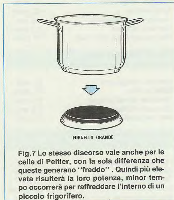
Fig.6 Se la piastra di un fornello eroga "poca potenza", occorrerà un tempo maggiore per portare ad ebollizione l'acqua contenuta in un recipiente, rispetto a quello necessario con una piastra più grande che eroga maggior potenza.
