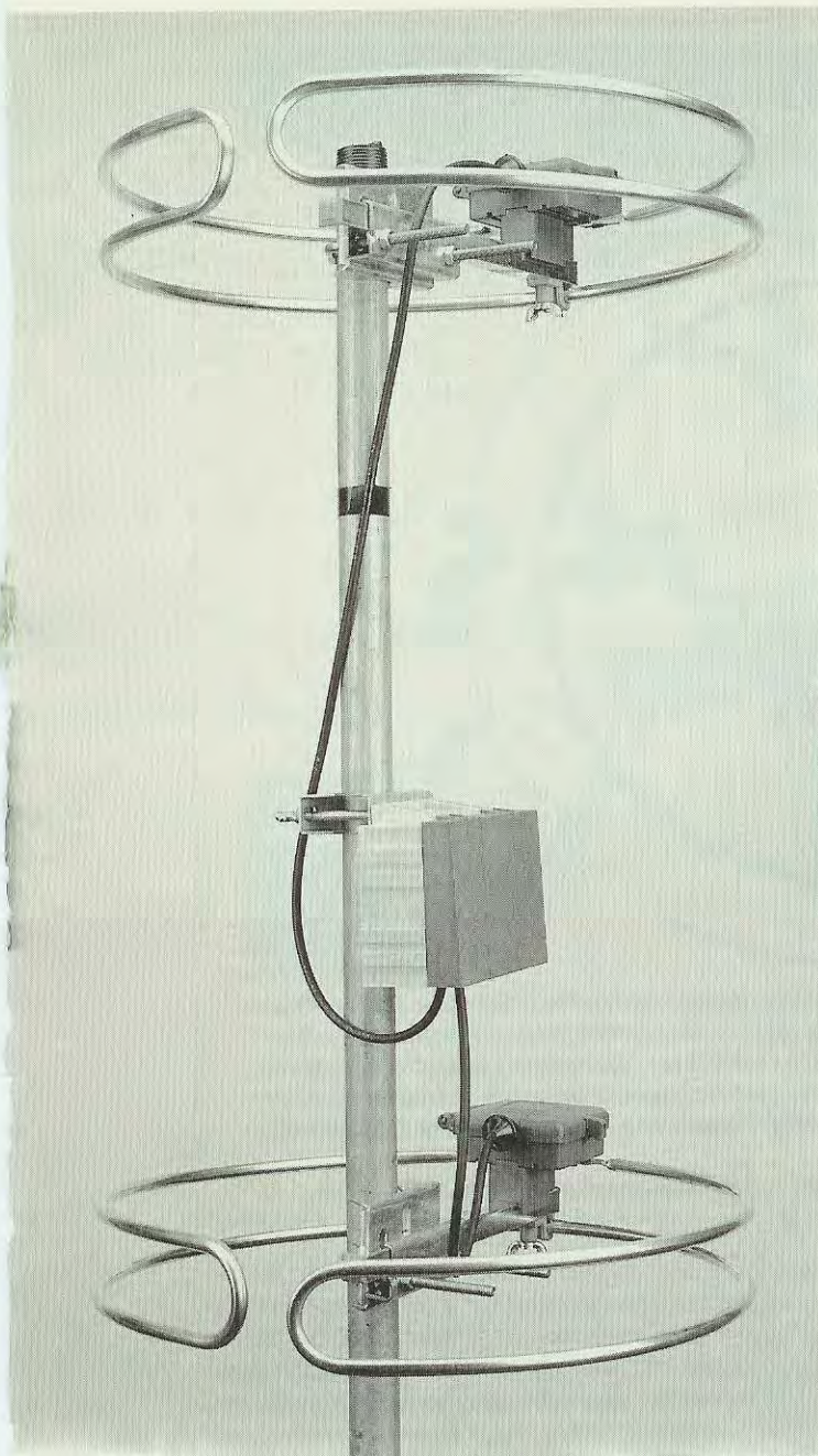
Fig.1 Foto dell'antenna circolare montata con il suo preamplificatore sul palo di sostegno. A sinistra, foto scattata da un satellite MET in orbita sopra il Mediterraneo orientale. Si notino la Grecia, le isole del Mar Egeo, il Mar Nero e i laghi nel territorio della Turchia. Ovviamente nella TV, tutte le foto appariranno in colore, perciò assai più suggestive di questa in bianco/nero.
