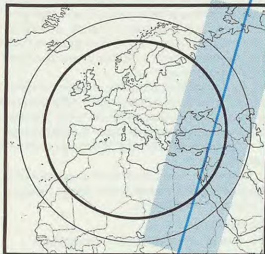
Fig.18 Quando il satellite passa sull'Italia, oppure sulla Grecia o sulla Francia, riceviamo il suo segnale, cioè le immagini, per circa 15-18 minuti, se invece passa molto lontano, ad esempio sul Mar Caspio o sulle isole Azzorre, lo riceviamo per soli 5-8 minuti, perchè subito dopo scompare dietro l'orizzonte.
