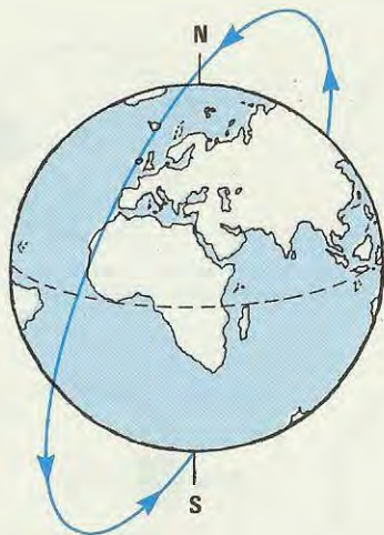
Fig. 15 Ruotando la Terra in senso antiorario, riusciremo a ricevere ciascun satellite 3 volte al mattino e 3 volte al pomeriggio. Se al mattino l'orbita risulta ascendente, cioè il satellite arriva da Sud e prosegue verso Nord, al pomeriggio risulta discendente, cioè arriva da Nord e prosegue verso Sud.
