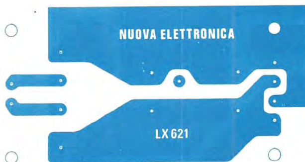
Fig. 6 Disegno a grandezza naturale del circuito stampato necessario per realizzare lo stadio alimentatore.
