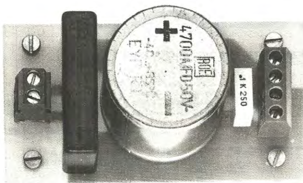
Nel montare il ponte raddrizzatore e il condensatore elettrolitico controllate che i terminali positivi siano rivolti come vedesi nella foto.
