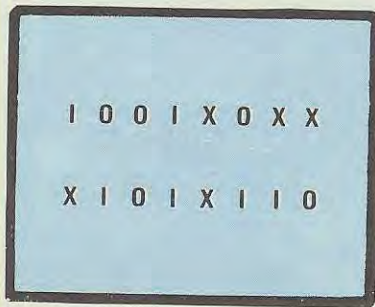
Fig. 1 Sullo schermo dell'oscilloscopio vi appariranno contemporaneamente tutte le condizioni logiche presenti sui 16 o 14 terminali dell'integrato sotto prova.
