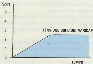
Fig. 2 Per un corretto funzionamento del PLL sarebbe necessario che la bobina oscillatrice AF potesse oscillare sulla frequenza desiderata applicando ai diodi varicap una tensione compresa tra i 2 e i 3 volt. Come vedesi da questo grafico, la tensione sul condensatore C1 lentamente da 0 volt salirà al valore richiesto.
