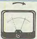
Fig. 12 Inserendo il quarzo e regolando il nucleo della bobina L1 e quello del compensatore di accordo posto sempre in parallelo a tale bobina si troverà una posizione dove la corrente bruscamente aumenterà, e a tale condizione significa che il quarzo oscilla.
