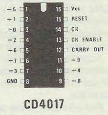
Fig. 1 Schema elettrico e connessioni degli integrati visti da sopra e del transistor e fet visti da sotto.
