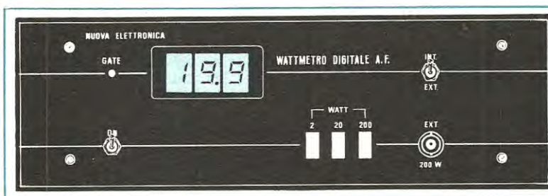
Fig. 11 Disegno della mascherina frontale del mobile.
