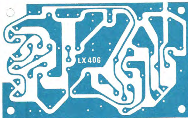
Fig. 2 Disegno a grandezza naturale del circuito stampato.
