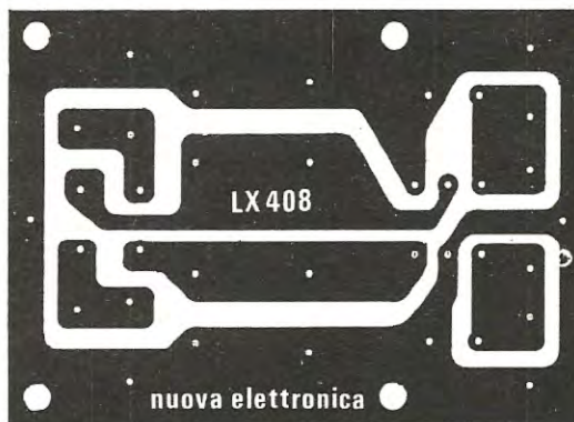
Fig. 3 Disegno a grandezza naturale del circuito stampato. In alto la foto del montaggio.
