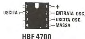
Fig. 2 Connessioni dei terminali dell'integrato HBF.4700 visto da sopra.
