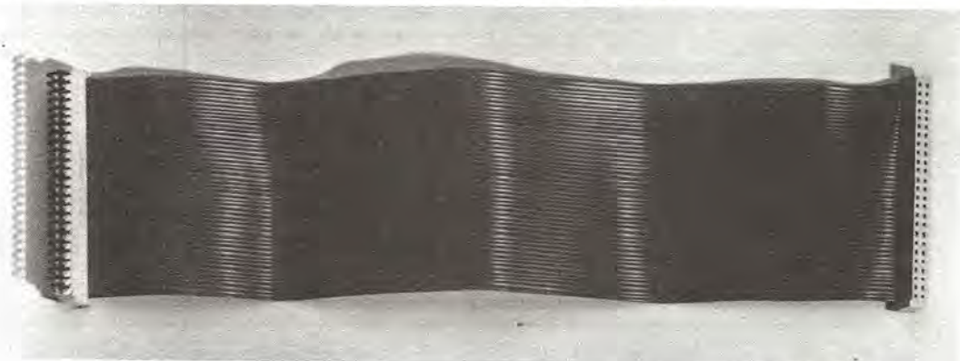
Fig. 14 Per evitare al lettore qualsiasi errore nelle connessioni dei 50 fili necessari per collegare il circuito stampato LX.285 alla tastiera si è pensato di utilizzare una piastrina completa ai suoi estremi di due connettori femmina, che s'innesteranno sui relativi maschi applicati ai circuiti stampati.
