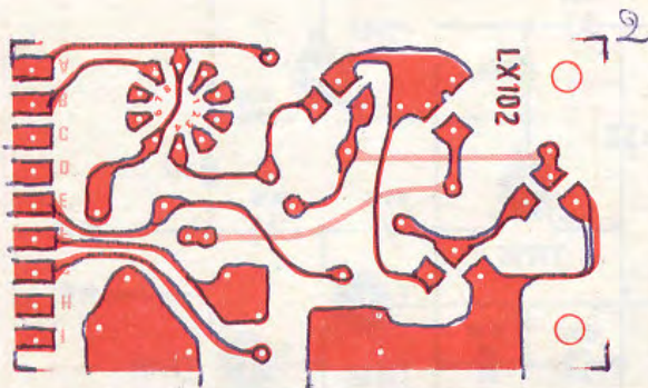
Fig. 7 Circuito stampato a grandezza naturale e a doppia faccia del telaio LX.102. Su ogni circuito stampato da noi fornito è stampato in serigrafia il disegno dei singoli componenti completi di sigla di identificazione.
