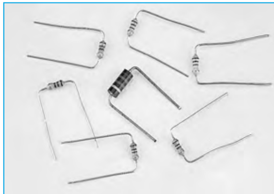
Fig.142 Prima di inserire tutte le resistenze ed i diodi nei fori presenti sul circuito stampato vi consigliamo di ripiegare ad U i loro terminali cercando di mantenere il corpo del componente al centro.
