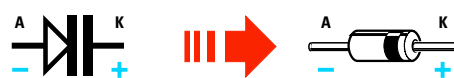
Fig.110 Il terminale K (Catodo) di questi diodi va sempre collegato al positivo di alimentazione tramite una resistenza.
