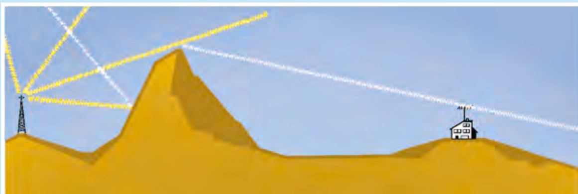
Fig.291 Le onde VHF - UHF presentano la caratteristica di poter essere riflesse - diffratte - rifratte se incontrano un ostacolo. In pratica si riflettono o si diffrangono come fa la luce con uno specchio e per questo motivo possono raggiungere zone in cui l'onda diretta non arriverebbe mai.
