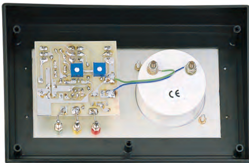
Fig.469 Prima di tarare il provatransistor dovete collegare assieme con un corto spezzone di filo i due terminali A-A. Se disponete di un Tester, dopo averlo commutato sulla portata 30 microamper fondo scala, collegate i suoi due terminali sulle boccole B-E come spiegato nel paragrafo "Taratura del provatransistor".
