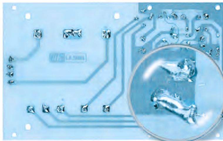
Fig.202 Se farete delle stagnature simili a queste difficilmente il circuito potrà funzionare. In questo caso dovrete rifarle seguendo le istruzioni riportate nella lezione N.5.
