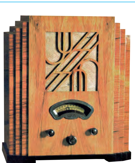
Fig.372 Con il passare degli anni si cercò di rendere il mobile di queste radio esteticamente sempre più moderno. Come potete notare, la scala della sintonia con sopra stampata la frequenza in KHz per le OM e in MHz per le OC, risulta più ampia.
