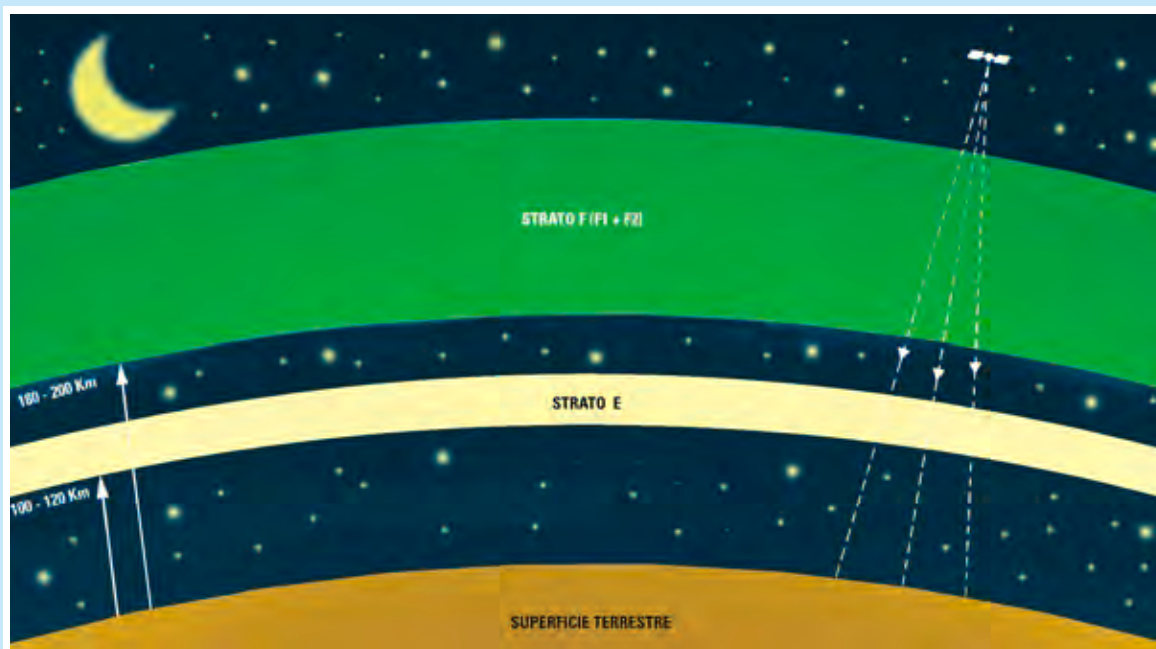
Fig.286 Durante le ore notturne lo strato D scompare e gli strati F2-F1 si congiungono formando un unico strato denominato F. Mancando lo strato D, che assorbiva le onde radio, queste riescono a raggiungere gli strati riflettenti E - F. Le frequenze VHF - UHF - SHF, riuscendo a "perforare" gli strati D - E - F, proseguono liberamente nello spazio.
