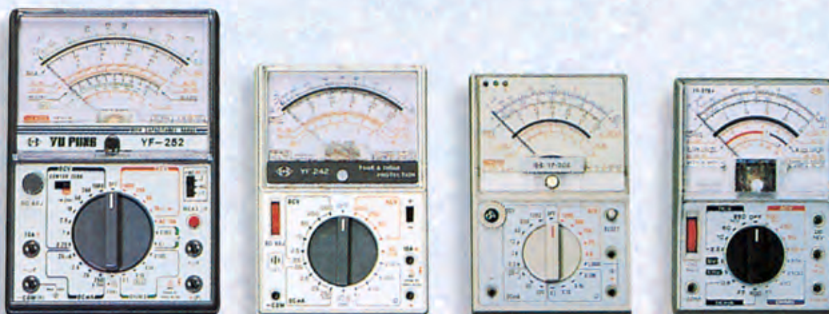
Fig.365 Se un giorno decideste di acquistare un Tester Analogico, sceglietene uno che abbia una sensibilità non inferiore a “20.000 ohm x volt” per ridurre gli errori di lettura.
