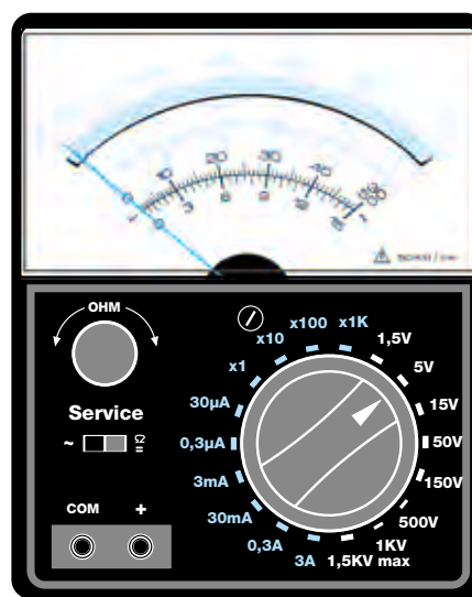
Fig.375 Nella funzione Voltmetro o Amperometro AC il valore della tensione o della corrente Alternata andrà letto sulla scala colorata in rosso. Prima di effettuare una misura AC, dovete ricordare di spostare la leva del microinterruttore dalla posizione CC-OHM alla posizione AC.
