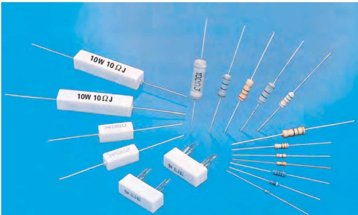
Fig.43 Le resistenze da 1/8 - 1/4 - 1/2 - 1 watt utilizzate in elettronica hanno la forma di piccoli cilindri provvisti di due sottili terminali. In queste resistenze il valore ohmico si ricava dalle quattro fasce colorate stampigliate sui loro corpi (vedi fig.46). Le resistenze da 3 - 5 - 7 - 10 - 15 watt hanno un corpo rettangolare in ceramica con sopra stampigliato il loro valore ohmico e la loro potenza in watt.
