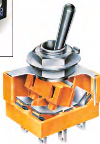
Fig.387 Gli interruttori e i deviatori possono avere forme e dimensioni diverse. I doppi deviatori, come potete vedere in questo disegno, racchiudono al loro interno due deviatori separati.
