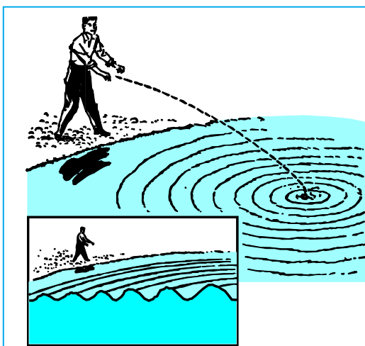
Fig.192 Per capire come si forma un'onda sonora provate a gettare un sasso in uno stagno d'acqua. Vedrete formarsi delle onde concentriche che si propagheranno dal centro verso l'esterno senza creare correnti, ma solo ondulazioni. Infatti posando sullo stagno un tappo di sughero lo vedremo solo alzarsi o abbassarsi, ma non spostarsi dalla sua posizione. Le onde sonore fanno oscillare le molecole d'aria senza muovere l'aria, a differenza delle pale del ventilatore che generano vento, ma non un suono.
