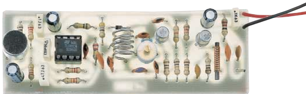
Fig.321 Foto del trasmettitore in FM. Il circuito stampato che vi forniremo risulta già forato e completo di disegno serigrafico. Per aumentare la portata, anziché utilizzare un'antenna lunga 73-74 cm, si potrebbe utilizzare un filo lungo 220 cm pari a 3/4 di lunghezza d'onda. Se userete lunghezze diverse, irradierete meno potenza.
