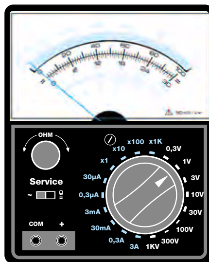
Fig.373 Nella funzione Voltmetro CC, ruotando la manopola sulle portate contrassegnate 0,3-3-30-300 V. il valore andrà letto sulla scala graduata da 0 a 30, ruotando la manopola sulle portate contrassegnate 1-10-100 V. il valore andrà letto sulla scala graduata da 0 a 100.
