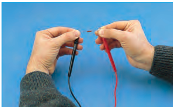
Fig.382 Quando misurate una resistenza non toccate i due terminali con le mani perchè il tester sommerà al valore della resistenza anche quello del vostro corpo.
