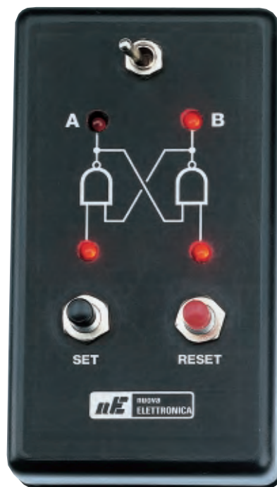
Fig.554 Il circuito di fig.553 viene racchiuso entro un piccolo mobiletto plastico sul quale andrà applicata l'etichetta autoadesiva prestampata e forata.
