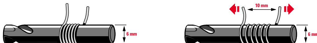
Fig.318 Per realizzare la bobina L1, avvolgete 5 spire unite su un tondino del diametro di 6 mm (supporto di una punta da trapano) usando il filo di rame nudo da 1 mm inserito nel kit. Dopo averle avvolte, prima di togliere la bobina dal supporto, spaziatele accuratamente in modo da ottenere un solenoide della lunghezza di 10 mm.
