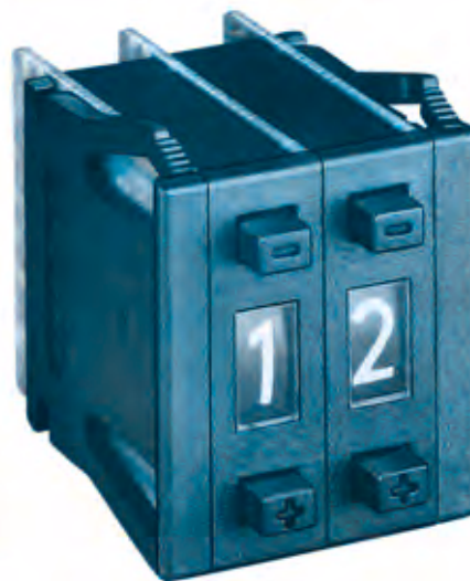
Fig.400 Nei commutatori digitali è presente una finestra in cui appare un numero da 0 a 9. In questa foto potete osservare due commutatori digitali appaiati.
