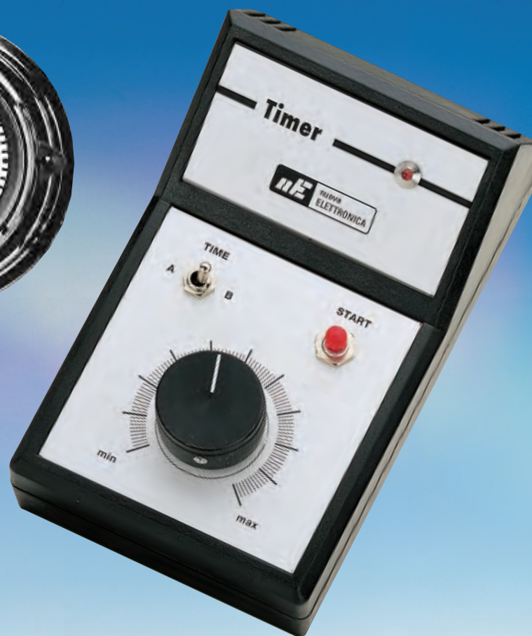
Fig.491 Ecco come si presentano i due temporizzatori dopo aver fissato sul coperchio del mobile il potenziometro, il deviatore, il pulsante e il diodo led. I pannelli di alluminio vanno fissati sul coperchio del mobile con un po' di collante cementatutto.
