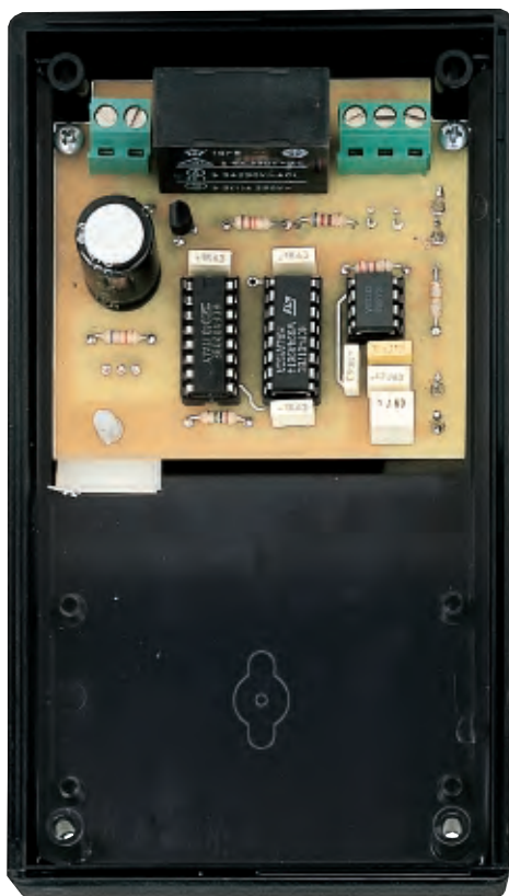
Fig.487 Fissate il circuito stampato sulla base del mobile per mezzo di due viti autofillettanti e di un distanziatore plastico provvisto di base autoadesiva.
