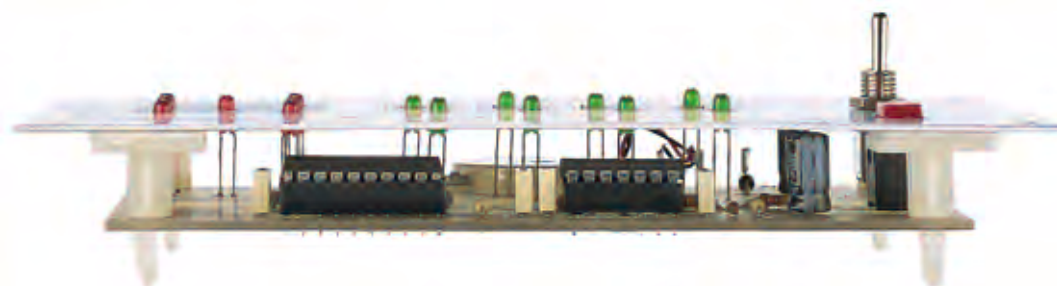
Fig.410 Una volta montati sullo stampato tutti i diodi led, inserendone il terminale più corto siglato K (vedi fig.411) nei fori che appaiono contrassegnati dalla lettera K (vedi fig.407), appoggiate sopra a questi la mascherina frontale, poi capovolgete il tutto e, dopo aver fatto fuoriuscire tutte le teste dei diodi led, saldature con cura i terminali.
