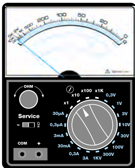
Fig.372 Nella funzione Ohmetro, il valore della resistenza letto sulla scala Ohm andrà moltiplicato per il fattore contrassegnato dalla manopola, cioè x1-x10-x100-x1K. Ogni volta che cambierete portata dovreste cortocircuitare i due puntali e ritoccare il potenziometro di taratura.
