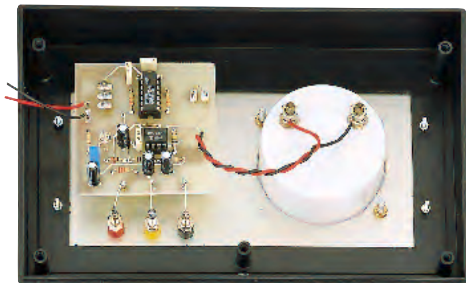
Fig.516 Il circuito stampato andrà fissato direttamente sul pannello frontale del mobile tramite i dadi del pulsante P1 e dell'interruttore S1 (vedi fig.522). Sul lato destro del pannello troverà posto lo strumento voltmetro da 5 volt fondo scala.
