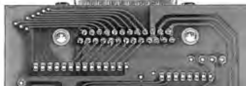
Fig.172 Per stagnare dei terminali molto ravvicinati, come quelli di un Connettore, conviene tenere il saldatore in posizione quasi verticale e sciogliere sui terminali pochissimo stagno per evitare dei corti.
