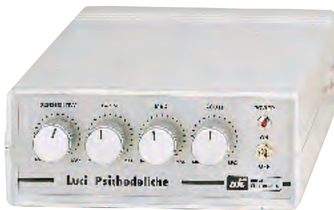
Fig.560 Ecco come si presenta il mobile per luci psichedeliche in grado di pilotare lampade da 12 volt.
