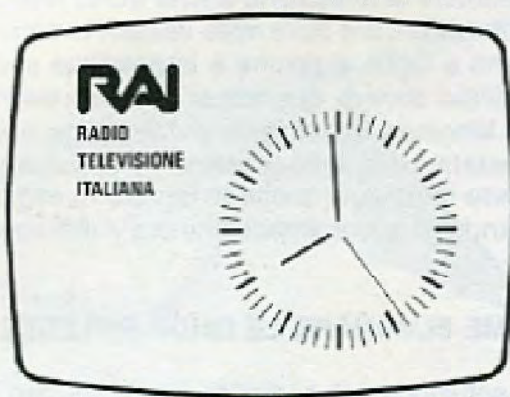
Fig. 12 Una riflessione si rileva facilmente quando sulla TV appare, prima del giornale radio, l'immagine dell'orologio. Se è presente, noteremo una seconda immagine più spostata verso destra rispetto all'immagine diretta.
