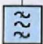
Fig.273 Un filtro "passa-banda" lascia passare tutti i canali che rientrano nella sola banda interessata, eliminando quelli presenti nelle bande superiori o inferiori.
