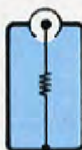
Fig.319 Le resistenze di chiusura linea "sprovviste" di condensatore di disaccoppiamento le potrete utilizzare dove non ESISTE tensione continua.
