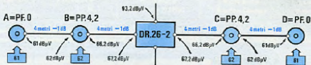
Fig.179 Se il derivatore preesistente fosse un DR.26/1, sapremmo già che andrebbe sostituito con un DR.26/2. Se inseriremo in tale impianto un derivatore modello DR.26/4, cioè con quattro uscite potremo aggiungere altre 4 prese e quindi arrivare ad un totale di 8 prese.
