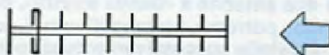
Fig. 60 Se si aumenta ancor di più il numero dei direttori, si riescono a raggiungere guadagni anche di 18 dB, vale a dire un aumento in tensione di ben 7,943 volte. Più aumenta il guadagno più l'antenna risulta direttiva, perché il lobo di irradiazione si restringe.
