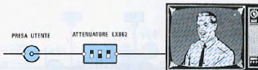
Fig. 195 Se non disponete di un Misuratore di Campo e volete controllare se su tutte le prese è presente un segnale sufficiente ed anche equalizzato, potrete sempre collegare in serie alla vostra TV l'attenuatore resistivo LX.862, pubblicato sul numero 120 di Nuova Elettronica.
