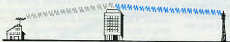
Fig. 8 Anche se tra noi e l'emittente è interposto un alto edificio, è ancora possibile ricevere il segnale TV per diffrazione.
