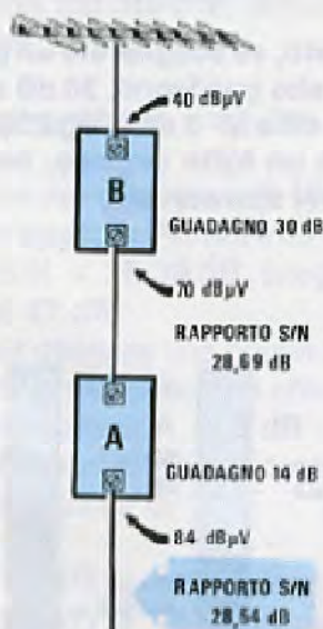
Fig.230 Se per errore collegherete all'antenna il preamplificatore (B) e dopo questo il preamplificatore (A), in uscita otterrete sempre un segnale di 84 dBmicrovolt, ma diventando il rapporto S/N più basso, l'immagine che ne ricaverete risulterà "scadente".
