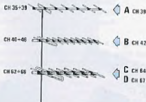
Fig.252 Per attenuare il segnale della sola emittente A e preamplificare il segnale della sola emittente B , lasciando inalterato il segnale delle due emittenti C e D , dovremo togliere l'antenna a larga banda e sostituirla con 3 antenne UHF , anche se le dovremo orientare entrambe nella stessa direzione.
