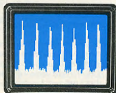
Fig.436 Dopo aver equalizzato i segnali di ogni Canale, eleveremo l'ampiezza dei segnali captati al valore richiesto ruotando i due trimmer presenti sullo stadio Finale di Potenza.
