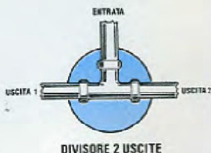
Fig.104 Se avete due colonne di discesa da collegare ad un contatore, vi servirà un Divisore con un ingresso e due uscite di identico diametro.
