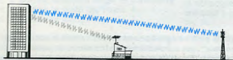
Fig. 10 Anche un edificio in cemento armato può provocare una riflessione, che si manifesterà come visibile nelle figg. 12-13.
