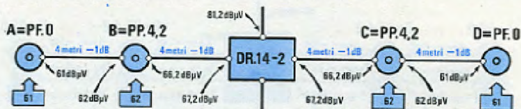
Fig.177 Utilizzando un Derivatore tipo DR.14/2 potremo aggiungere anche una quarta presa tipo PF.0 collegandola all'uscita della presa Passante PP.4,2. Poichè nella fig.176 la presa PP.4,2 visibile sulla destra veniva utilizzata come "terminale", abbiamo inserito la resistenza di chiusura linea.
