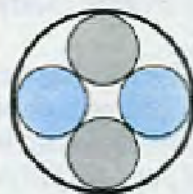
Fig. 27 Se i "canali" sono quattro, dovremo "ridurre" il loro diametro, in pratica dovremo attenuare la massima ampiezza dei segnali per evitare interferenze.
