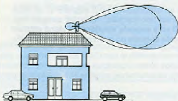
Fig. 17 Il lobo in senso verticale di due antenne accoppiate sul piano orizzontale non subisce, eccetto l'aumento di guadagno, alcuna variazione.
