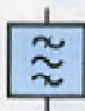
Fig.271 Un filtro passa-canale serve per attenuare fortemente tutti i canali interessati e lasciar passare senza alcuna attenuazione il solo canale su cui risulta sintonizzato. In pratica, il canale sintonizzato subisce un'attenuazione di circa 1 dB.
