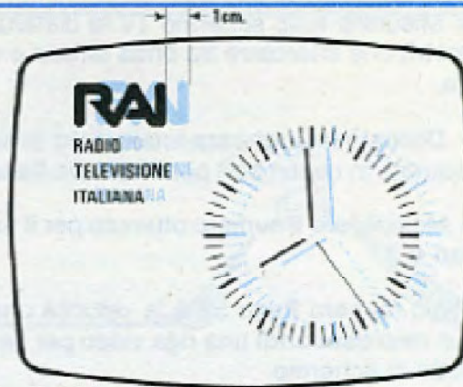
Fig. 13 Misurando la distanza che intercorre tra l'immagine diretta e quella riflessa, è possibile determinare approssimativamente a quale distanza dalla vostra antenna si verifica tale riflessione (leggere articolo).
