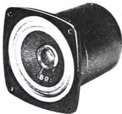
Fig.13 Gli altoparlanti Midrange da inserire in una Cassa Acustica si riconoscono da quelli a larga banda perché posteriormente sono chiusi da un involucro metallico per proteggere il cono dalla pressione interna della cassa creata dal Woofers.
