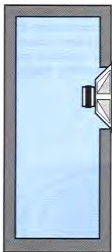
Fig.10 La cassa acustica Chiusa viene anche chiamata a Sospensione Pneumatica.
