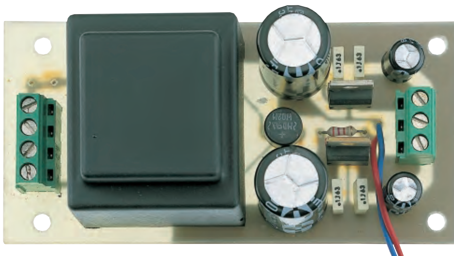
Fig.12 Come si presenta lo stadio di alimentazione LX.1199 una volta montato sul circuito stampato. La realizzazione di questa scheda non presenta particolari difficoltà: per quanto riguarda il montaggio dei condensatori elettrolitici e del ponte raddrizzatore rispettate la polarità dei terminali; per quanto riguarda gli integrati stabilizzatori fate attenzione a non confondere le sigle e innestateli con il lato metallico rivolto verso l'alto.
