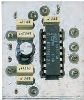
Fig.11 Ecco come si presenta a montaggio ultimato l'amplificatore Stereo. Il circuito stampato necessario alla sua realizzazione è un doppia faccia con fori metallizzati.
