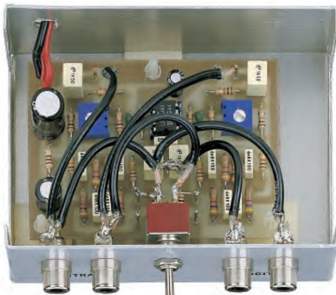
Fig.4 Il circuito stampato va fissato dentro un piccolo contenitore in alluminio utilizzando tre distanziatori plastici con base autoadesiva.
