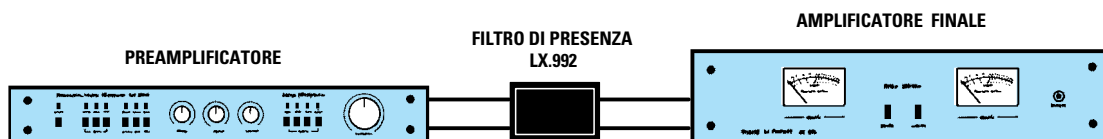
Fig.6 Il filtro di presenza va collegato tra l'uscita del preamplificatore e l'ingresso dello stadio finale di potenza. Per evitare di captare del ronzio di alternata, vi suggeriamo di utilizzare per questi collegamenti esterni del cavetto schermato.
