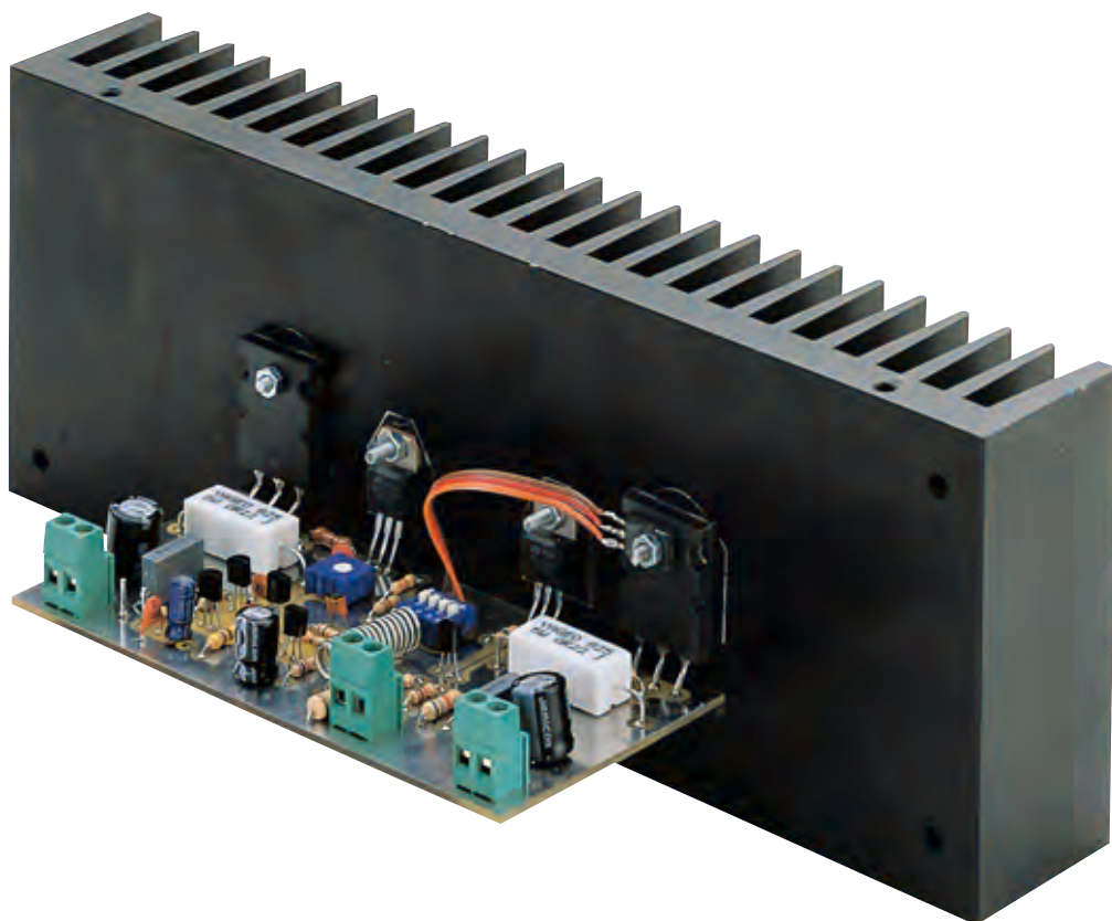
Fig.11 Il circuito stampato dell'amplificatore LX.1472 resta saldamente bloccato all'aletta di raffreddamento tramite i corpi dei transistor, pertanto, dopo averli fissati, controllate con un tester che il metallo dei loro corpi sia perfettamente isolato dall'aletta.
