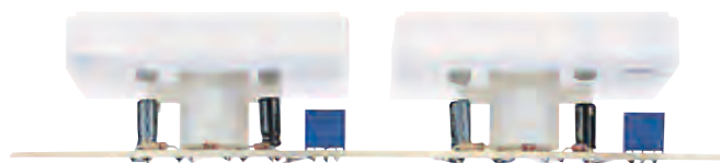
Fig.24 Come visibile in questa foto, gli strumenti verranno direttamente fissati sul circuito stampato dal lato dei componenti (vedi schema pratico in fig.26).
