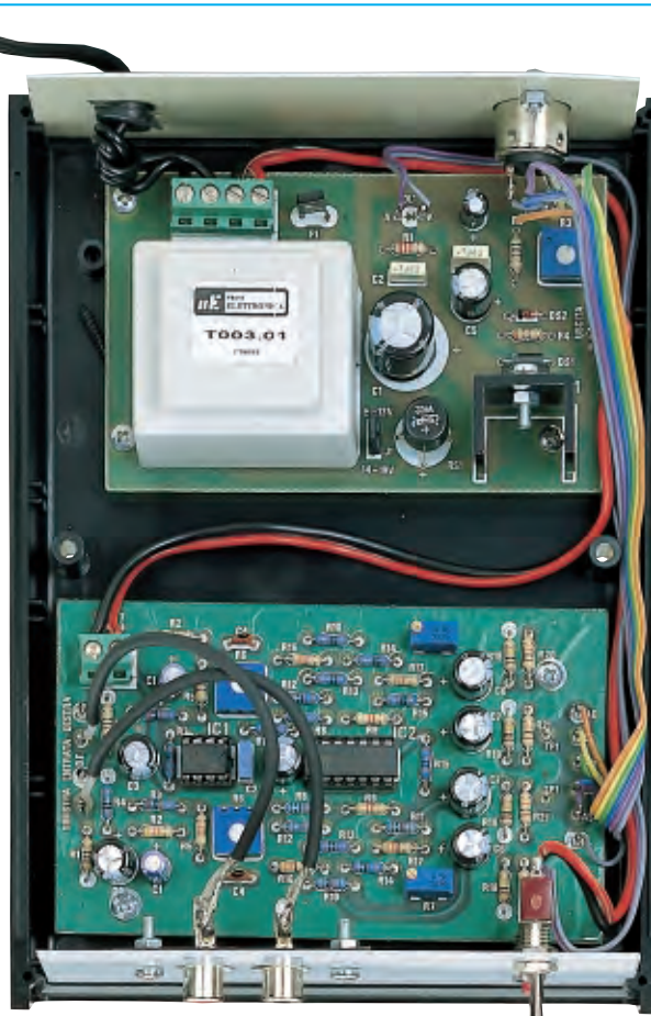
Fig.6 In questa foto potete vedere la disposizione all'interno del mobile del circuito bilanciante LX.1172 e del circuito di alimentazione LX.1174, pubblicato in questo volume, in grado di erogare una tensione stabilizzata di 15 volt. Entrambi i circuiti vanno fissati sul piano del mobile con delle viti autofilettanti.
