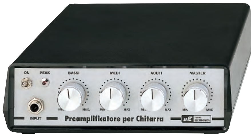
Fig.1 Foto del mobile plastico realizzato per il preamplificatore per chitarra. Il diodo led Peak vi consente di avere in ogni momento un controllo visivo di picco massimo.
