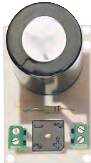
Fig.11 Sul circuito stampato siglato LX.1239 dovrete montare il ponte raddrizzatore RS1, il condensatore elettrolitico C9 e la resistenza R14. Nella fig.12 sono visibili tutti i collegamenti che dovrete effettuare.
