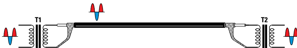
Fig.2 Se si utilizza un cavetto schermato per trasferire un segnale BF da una Sorgente (vedi T1) verso l'ingresso di uno stadio preamplificatore (vedi T2), qualsiasi ronzio o disturbo captato dalla calza di schermo giungerà sul primario del trasformatore T2 assieme al segnale BF, che scorre sia nel filo interno sia nella calza di schermo.
