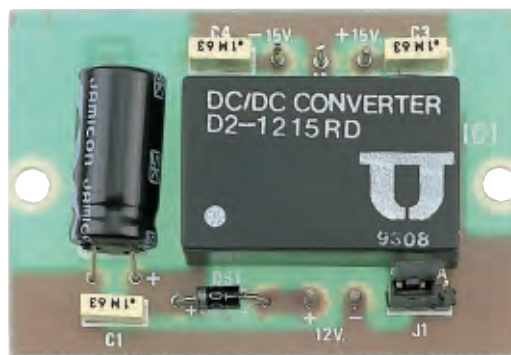
Fig.14 Schema pratico e foto del montaggio dell'alimentatore CC/CC. Per un corretto montaggio, il condensatore elettrolitico C2 va saldato in posizione orizzontale e la fascia bianca del diodo al silicio DS1 va rivolta verso sinistra. Tramite il ponticello J1 si eliminano gli eventuali disturbi spuri generati dall'impianto auto.
