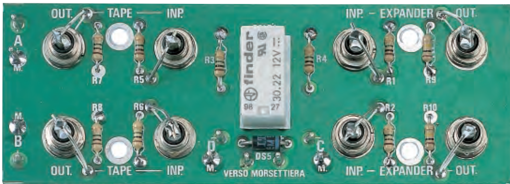
Fig.14 Foto della scheda LX.1177/A vista dal lato in cui vanno montati i pochi componenti contraddistinti da un asterisco nell'elenco componenti. Anche il montaggio di questa scheda non presenta difficoltà: ricordate solo di rivolgere la fascia bianca del diodo al silicio verso destra e di collegare le prese al circuito con corti spezzoni di filo.
