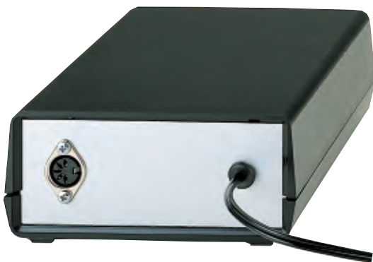
Fig.15 Sul pannello posteriore del mobile in cui va inserito il circuito LX.1172 fate un foro per la presa femmina ed uno per il cordone di alimentazione. Per il piano di foratura guardate il disegno di fig.17.
