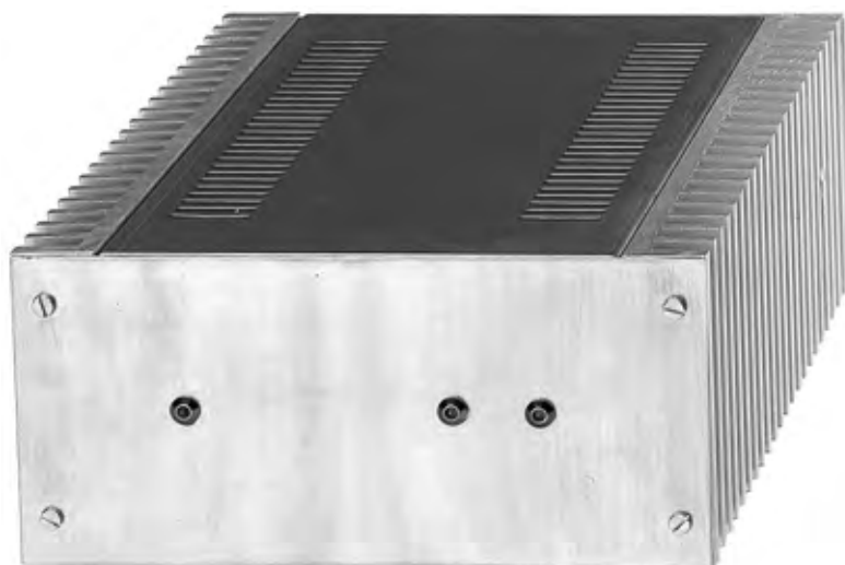
Fig.1 Foto del mobile metallico completo delle alette laterali di raffreddamento utilizzato per contenere l'alimentatore siglato LX.1229 in grado di fornire 55+55 volt 2 amper.
