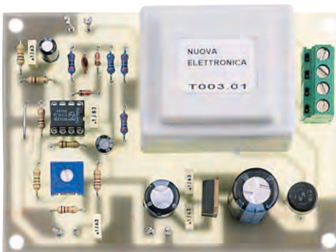
Fig.12 Foto dello stadio LX.1392/B . Sul lato sinistro dell'integrato IC3 dovete inserire un corto spezzone di rame per collegare la piazzola in rame che fa capo alle resistenze R21-R25 alla boccia d'uscita negativa per il tester.
