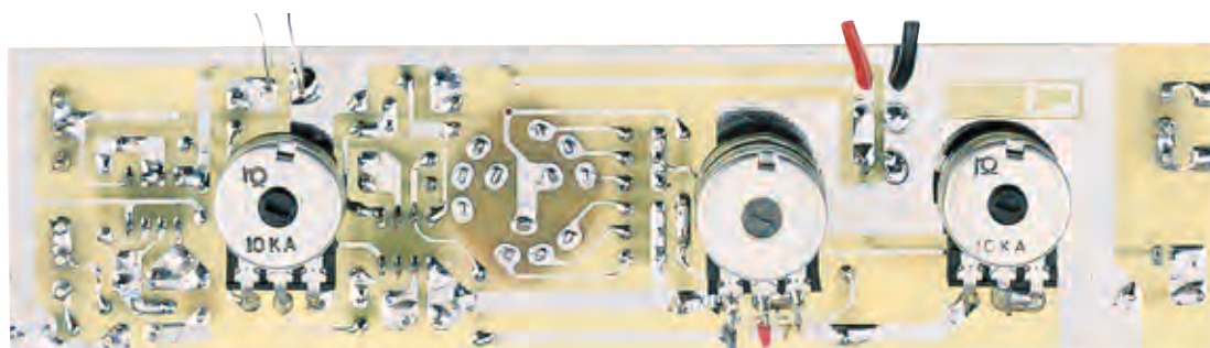
Fig.9 Sul retro del circuito stampato sono visibili i tre soli potenziometri. Al centro andrà inserito il doppio potenziometro lineare da 100.000 ohm siglato R9-R13 (vedi fig.4).
