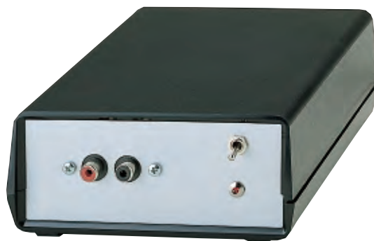
Fig.16 Sul pannello frontale dello stesso mobile dovete fare i fori per le due prese d'uscita, per l'interruttore e per il diodo led. Potrete disporre i fori anche in modo diverso da come appare in questa foto.
