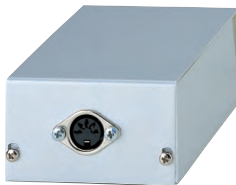
Fig.10 Poiché il contenitore metallico per il circuito LX.1173 è un modello standard sprovvisto di fori, dovrete fare da un lato un foro di 15 mm di diametro per il connettore femmina. Se non possedete una punta da trapano da 15 mm, potete fare tanti piccoli fori attorno alla sua circonferenza e poi limarli, in modo da ottenere un preciso e perfetto foro tondo.
