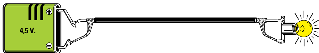
Fig.1 Se si utilizza un cavetto schermato per accendere una lampadina si deve collegare il filo interno al positivo della pila e la calza di schermo al negativo della pila o viceversa. Nella calza di schermo scorre dunque una tensione identica a quella del filo interno.
