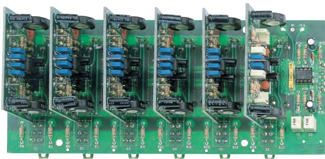
Fig.26 Foto dello stadio miscelatore LX.900 con sopra innestati i sei stadi d'ingresso LX.901-902. Quando inserite le schede d'ingresso nei connettori femmina, collocate quella equalizzata RIAA e quella con sensibilità 5 millivolt sull'estrema sinistra dello stampato, in modo che si trovino il più lontano possibile dallo stadio di alimentazione. Se non adottaste questo piccolo accorgimento, potreste captare del ronzio di alternata.
