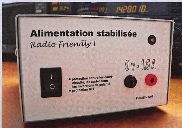
L'alimentation "propre", ne générant pas d'interférences radioélectriques.
