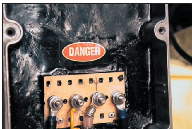
La fixation du coaxial par cosses.
