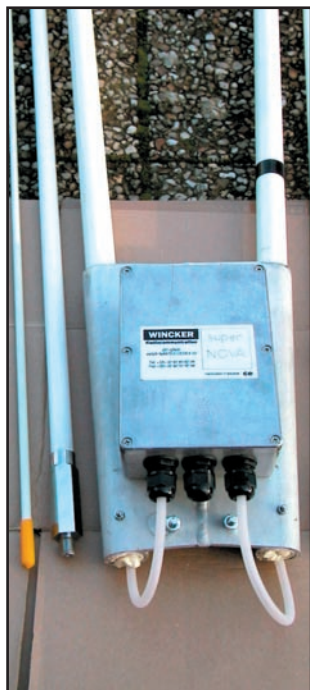
Le système de fixation à la base des brins.
