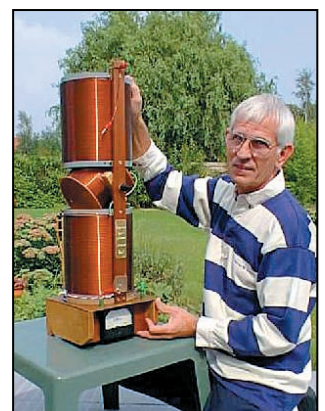
Le variomètre à la base de l'antenne de ON6ND.
