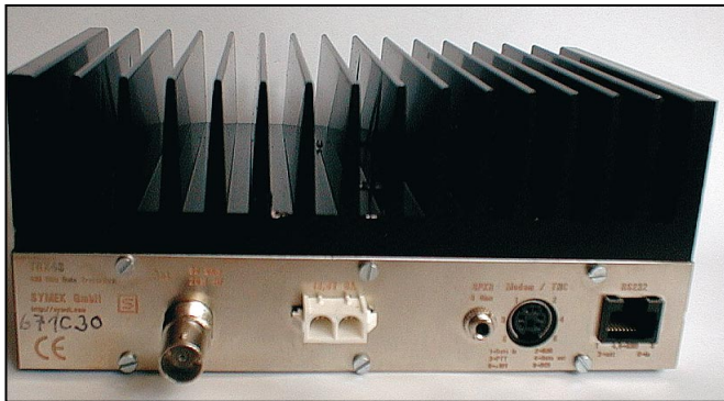
Face arrière du TRX4S, avec prise RS232, connecteur de données, alimentation et sortie d'antenne BNC.
