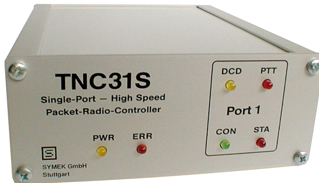
Le TNC31S, contrôleur packet 16 bits avec modem 153600 bauds.
