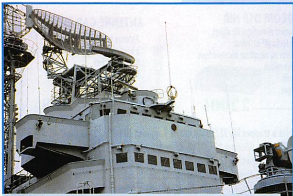
De haut en bas : antennes radar DRBV 23 C 23 cm veille aérienne DRBV 50 5 cm veille combinée DECCA 1226 3 cm navigation maritime.
