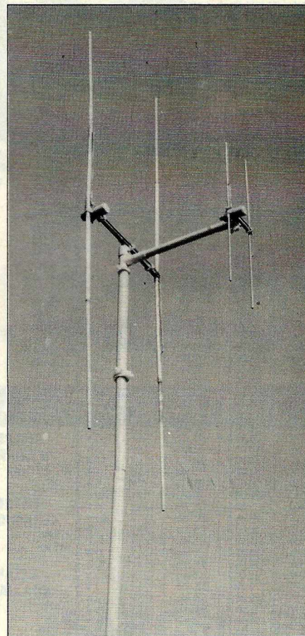
Photo B : HB9CV bande des 2 mètres, vue côté ligne de déphasage.
