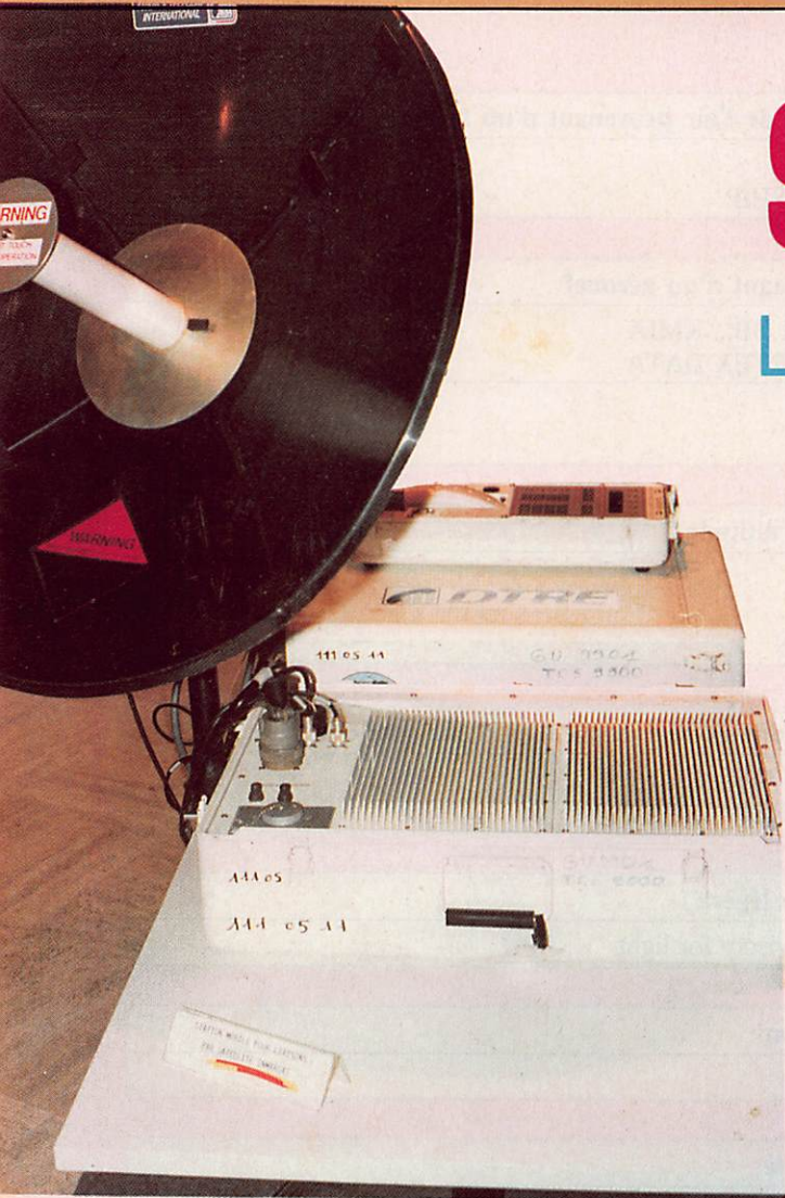
Station portable de radiotéléphonie par satellite sur le stand de la DTRE.
