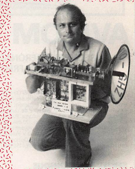
F6BCU présente l'émetteur-récepteur SSB 10 GHz qui a permis d'effectuer la liaison bilatérale de 346 km.
