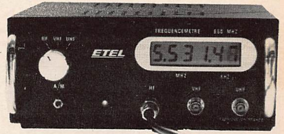
Fréquence-mètre 400 Hertz à 500 MHz 12 V/220 V. 3 entrées : HF - VHF - UHF. Afficheur à cristaux liquides. Sensibilité : 20 mV. Livré en 12 V.
