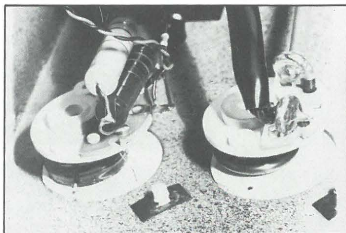
Détail des branchements sur les vu-mètres.
