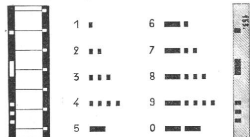
FIG. 4. — Code de marquage pour la synchronisation optique entre le film muet et la bande magnétique (Auto Script Martin)
