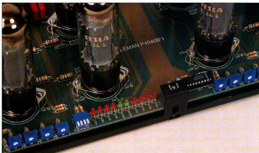
Sacrilège, un circuit intégré ! Il s'agit simplement du voltmètre destiné à l'équilibrage des courants de repos des tubes de puissance.
