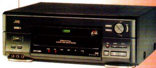
Magnétoscope D-VHS JVC, le HM-DSR100. Il incorpore un tuner DBS. Le D-VHS (digital VHS) peut lire toute votre "cassétothèque" VHS.
