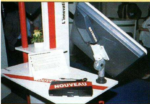
Chez Kathrein, l'UFD 346 reçoit non seulement la télévision par satellite mais aussi la radio ADR, il fonctionne sur une tension de 12 à 24 V et s'adapte aux configurations mobiles. A droite, l'antenne plane à double polarisation, elle réunit une collection de cornets connectés par guides d'ondes.
