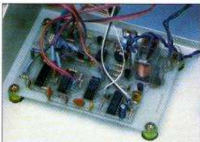
La platine se tient sur quatre entretoises collées au fond du boîtier. Les liaisons se font sur des fils, on peut protéger les soudures par de la gaine isolante.
