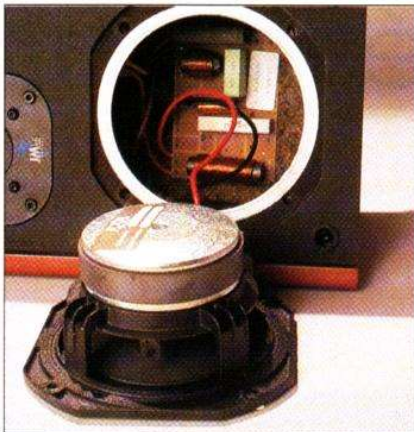
Vue interne de la Scénic ; boomer ôté, on distingue le filtre
