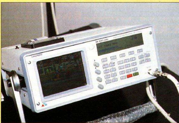
Le récepteur de mesure ME 900 Color de Grundig, il est équipé d'un écran à cristaux liquides et d'une imprimante.
