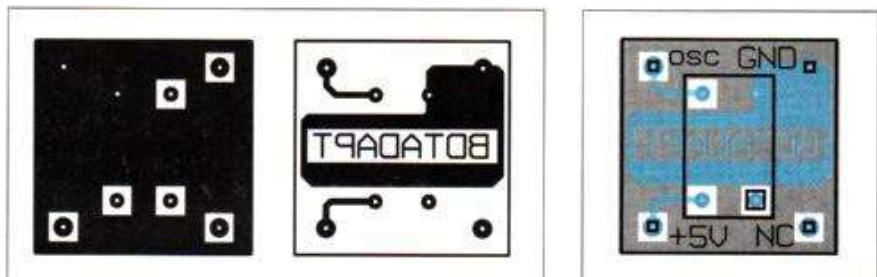
Circuit imprimé côté cuivre (gauche), côté composants (droite) et implantation pour la carte d'adaptation du TCXO.
