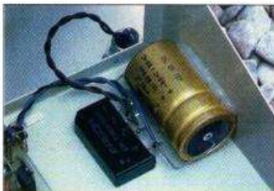
Un simple collage suffit à maintenir condensateur de filtrage et redresseur en place.
