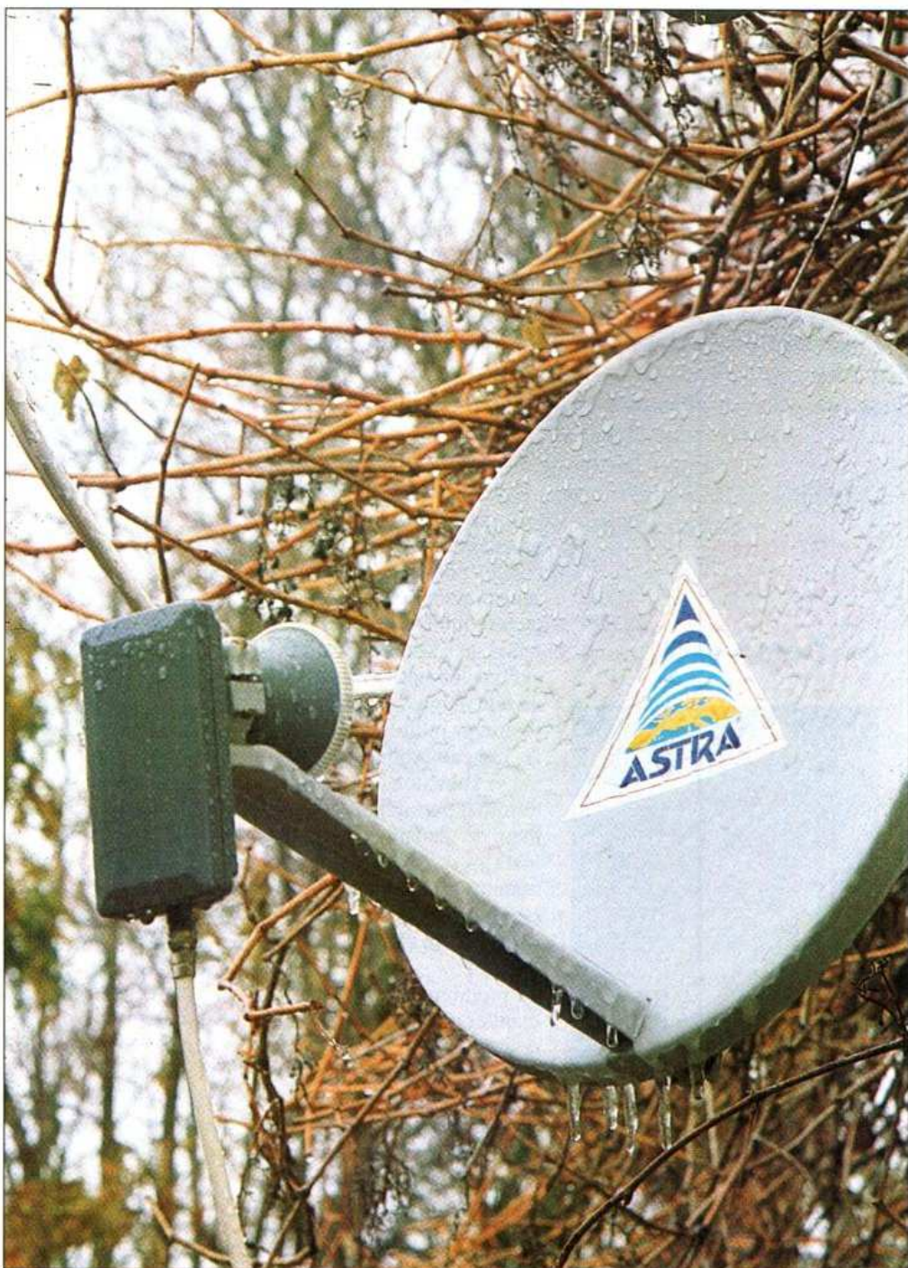
Une toute petite antenne, de structure classique, offset, ici dans des conditions de réception particulièrement difficiles..., elle est recouverte de verglas.
