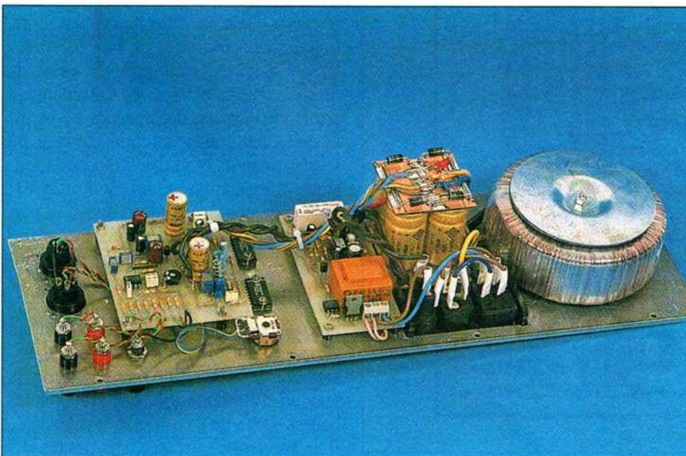
Vue générale du module d'amplification.
