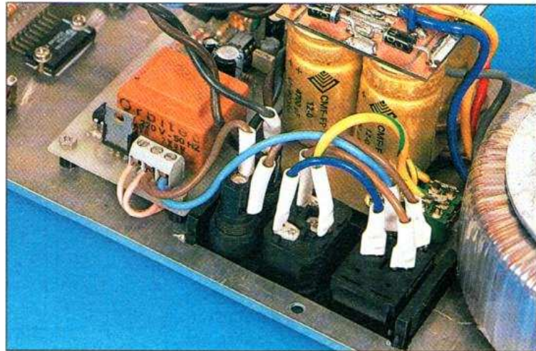
Un bloc de prises s'insère dans la face arrière et comporte l'entrée secteur, l'interrupteur général, ainsi qu'une paire de fusibles.
