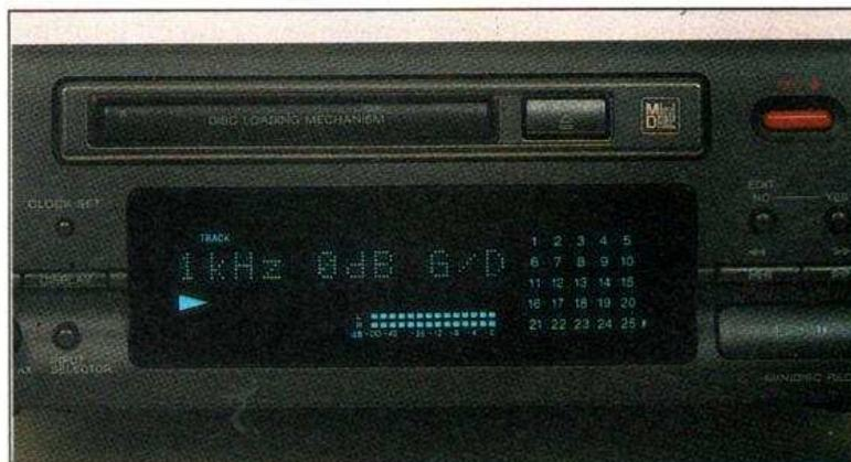
Un disque test très pratique : on y lit le contenu des plages, lettres majuscules et minuscules sont combinées avec des chiffres. Le calendrier montre qu'il y a plus de 25 plages.
