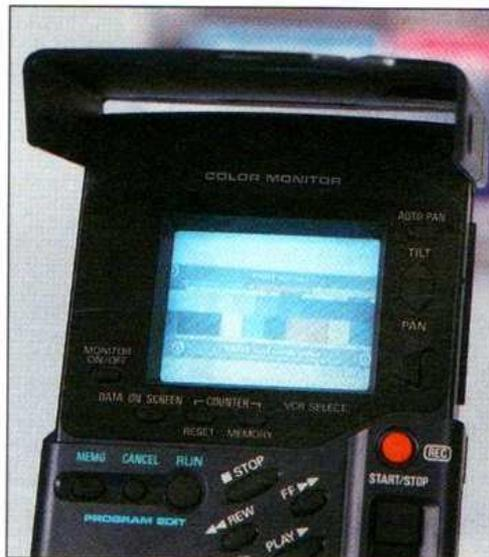
**Le moniteur est installé à la partie supérieure de la télécommande. Sur la droite, des touches seront utilisées pour commander la tourelle motorisée proposée par Sanyo.**
