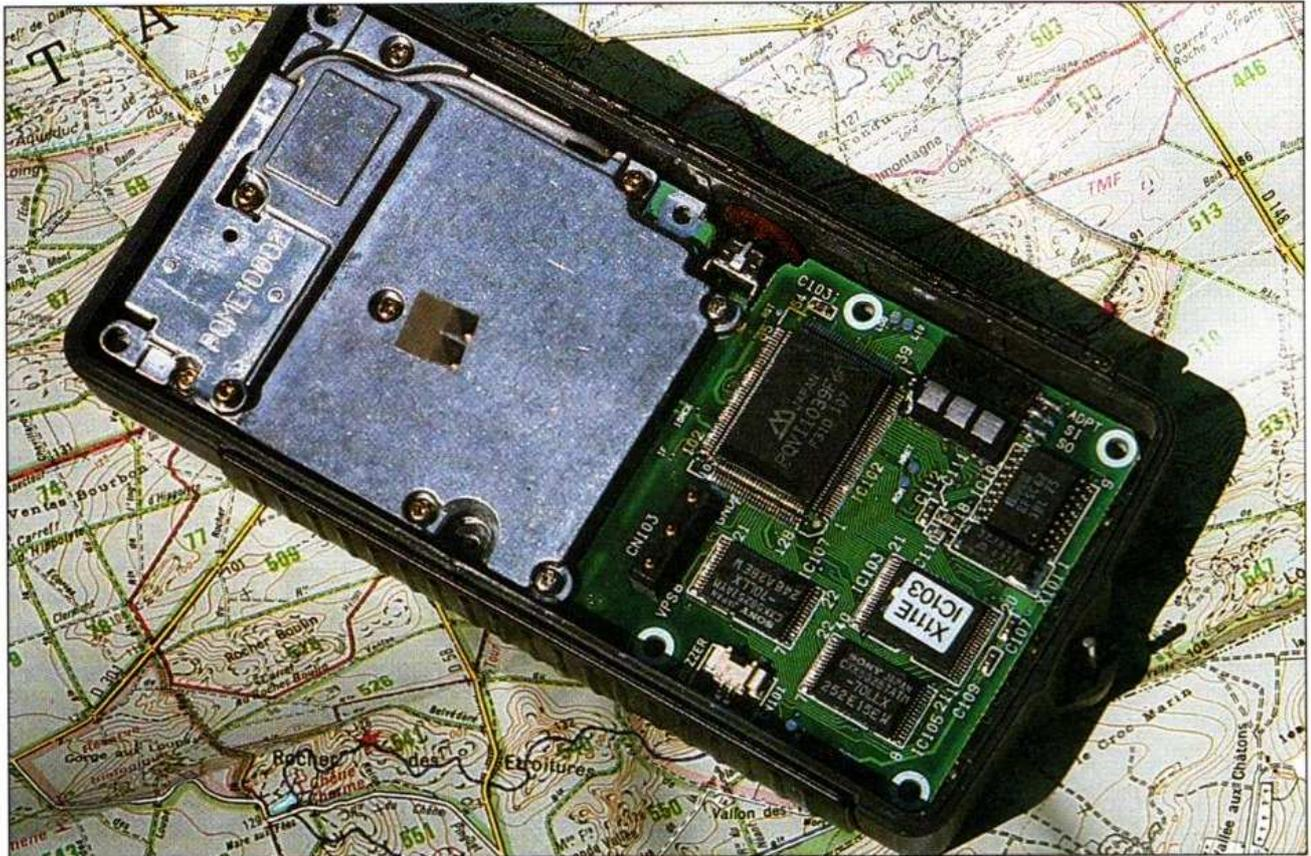
La batterie extra-plate est de technologie Nickel-Métal Hydride, les contacts permettent aussi un travail direct sur 12 V.
