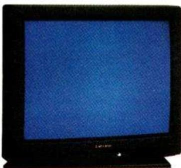
couleur à votre goût. L'écran teinté anti-reflets améliore les contrastes. Côté son, le 33B3 est équipé de deux haut-parleurs latéraux et d'un subwoofer au centre, alimentés par un amplificateur de 40 W. Il dispose, en façade, d'une entrée S-VHS et d'une entrée AV composite ; à l'arrière, de deux prises péritélévision et d'une prise S-VHS. C'est un PAL-SECAM BGIL (NTSC en vidéo) avec télétexte (13 990 F).
