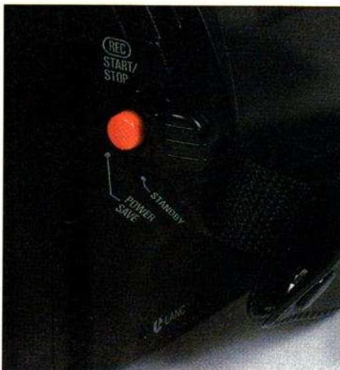
**Le bouton rouge déclenche la prise de vues ou l'arrête, la mise sous tension se fait par le commutateur rotatif.**
