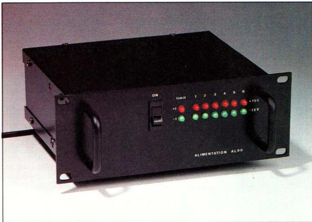
Une alimentation pour un seul module devrait fournir les deux tensions requises (+ et - 15 V) avec une capacité en courant de 200 à 500 mA, cette dernière valeur assurant une marge de sécurité pour les modules déjà publiés. Cette alimentation peut être réalisée selon une structure assez simple et plutôt classique.
