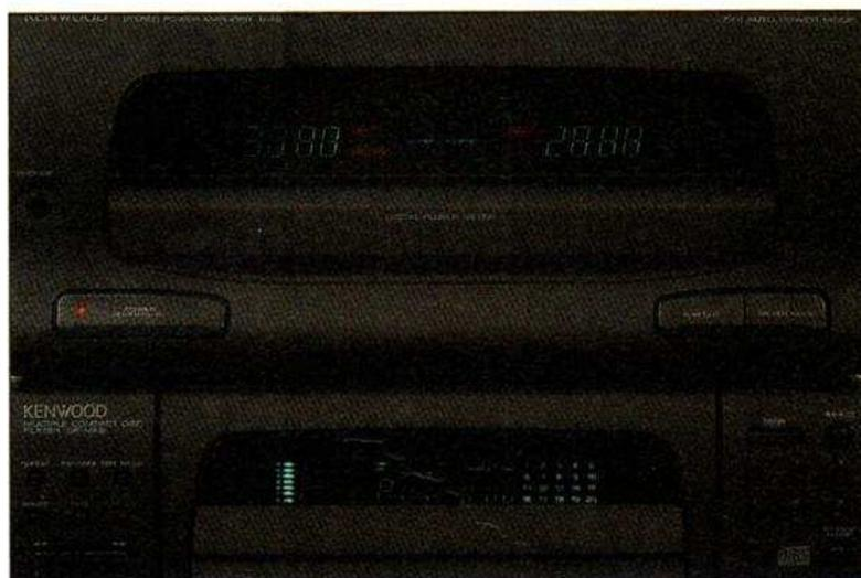
Deux indicateurs : celui du dessus annonce la puissance avec quatre chiffres significatifs mais a bien du mal à se stabiliser ! Celui du bas correspond au lecteur de CD ; à gauche, figurent les disques présents ou non dans les deux chargeurs à 6 et 1 disques.
