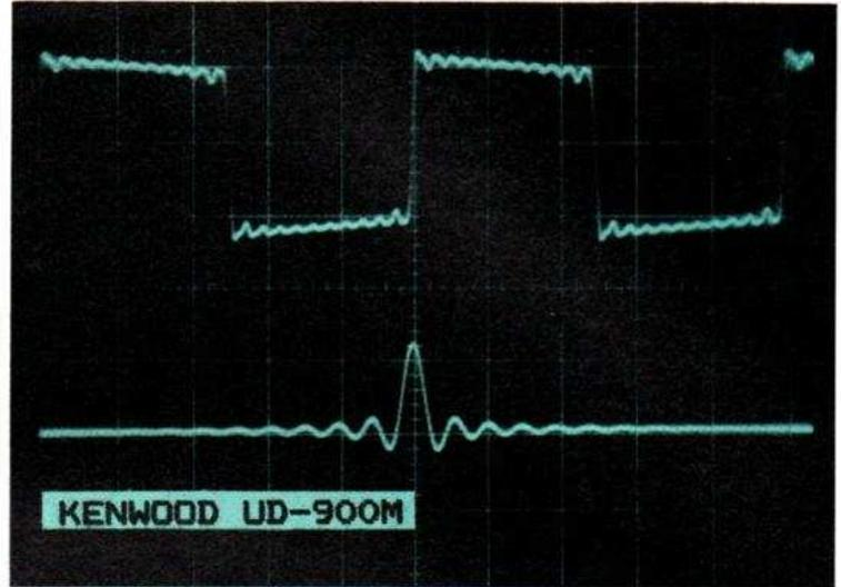
**Réponse de la chaîne aux signaux carrés.** Nous avons ici le toit incliné caractéristique d'une atténuation du grave. L'échelle verticale est de 10 V/division, nous sommes en sortie de l'amplificateur de puissance, l'échelle horizontale de 200  $\mu$ s par division pour les carrés, 100 pour l'impulsion, cette dernière est tout à fait classique.
