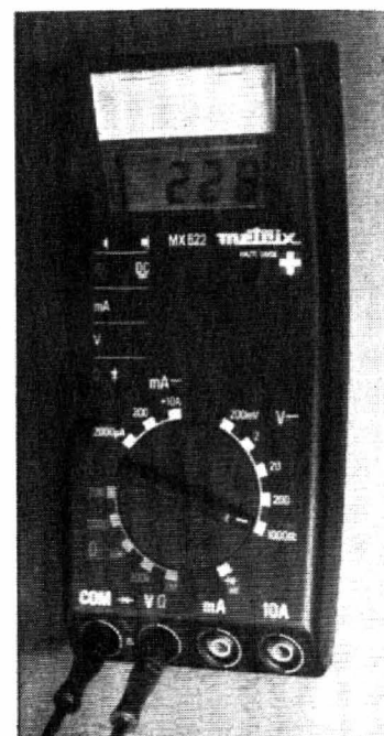
Photo A. - Vue extérieure du multimètre MX522. Affichage en 2000 points de mesure par chiffres 7 segments à cristaux liquides. Polarité affichée automatiquement pour les valeurs négatives. Calibres : 5 pour les tensions continues ou alternatives. Résistance d'entrée 2 M \Omega . Résolution maximale : 100 \mu V ; 3 pour les intensités continues ou alternatives. Résolution maximale : 1 \mu A ; 5 pour les résistances. Résolution maximale : 0,1 \Omega . Contrôle des diodes.
