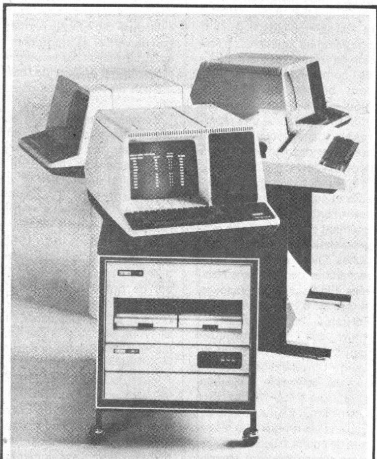
Photo 11. - Le MU/11V03 est un système informatique conçu directement pour les salles de classe. Il est petit : ses dimensions sont inférieures au pupitre du chargé de cours. Il est même portable : le processeur, la mémoire à disques et tout le matériel annexe tiennent dans une seule armoire. Le système d'exploitation permet au système de fonctionner en temps réel interactif, avec un vaste choix de programmes (Basic, Fortran IV, APL).
