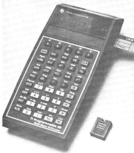
Photo A. - La plus puissante de la famille, la TI 59. Le petit module du bas est une bibliothèque de 4000 bits... La TI 59 dispose aussi d'un lecteur de cartes magnétiques.
