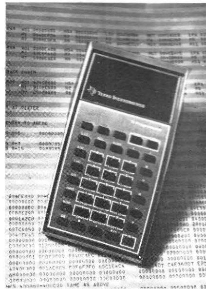
Photo C. - L'aide aux programmeurs. La machine de conversion hexadécimal/octal/décimal, dispose aussi de fonctions logiques.
