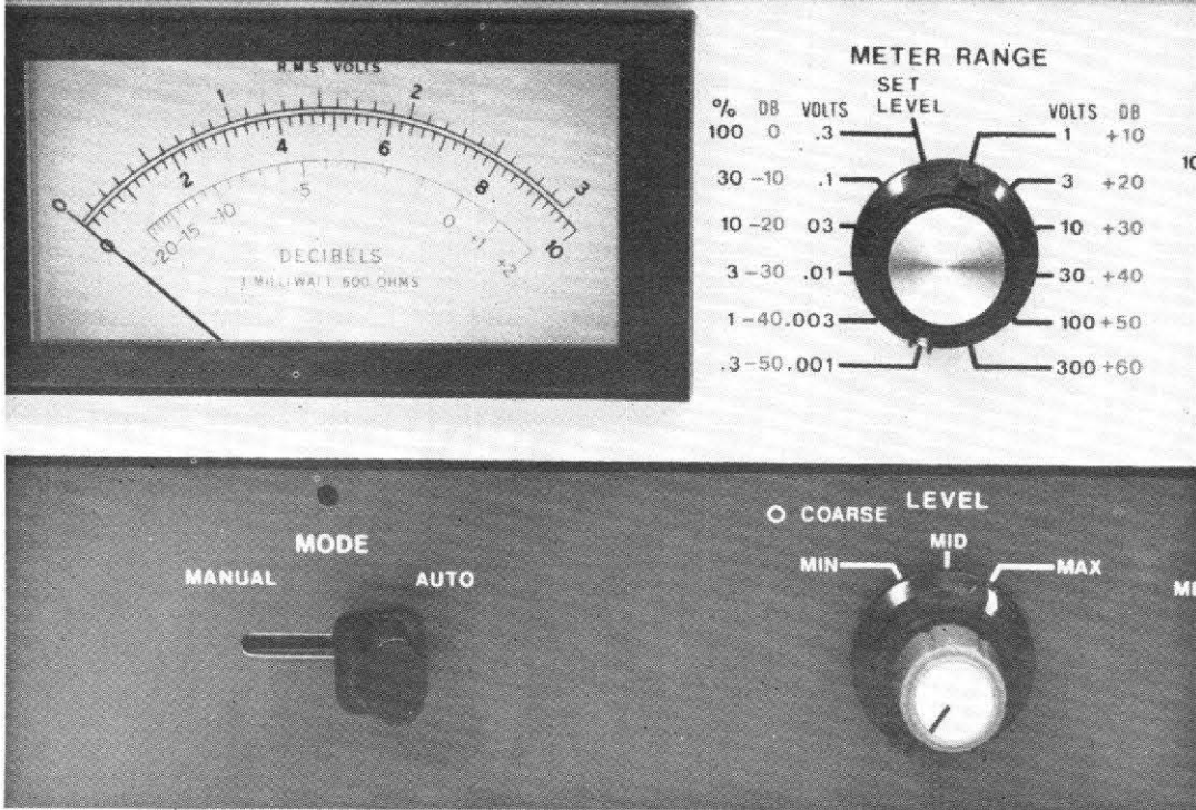
Photo B. - Un cadran clair, éclairé par l'arrière. Un commutateur de sensibilité à trois échelles, un commutateur de mode de fonctionnement, automatique ou manuel.
