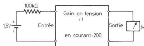
Fig. 22. - Interposons, entre la source de la figure 21 et le voltmètre M, un étage amplificateur de courant, de gain 1 en tension, nous pouvons facilement mesurer la valeur de la F.E.M. de la source.
