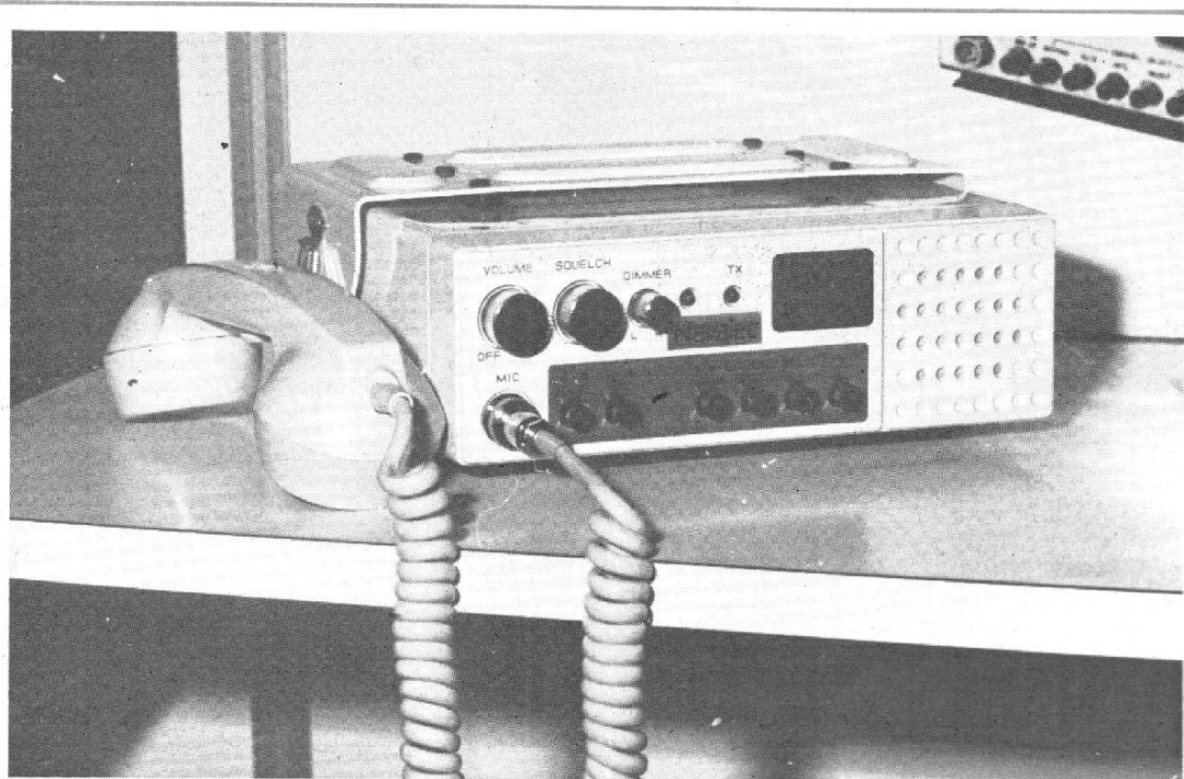
Photo 9. - Ce radio téléphone de Navalec possède un synthétiseur de fréquence incorporé. L'affichage est digital, les étages de puissance HF sont à transistors.
