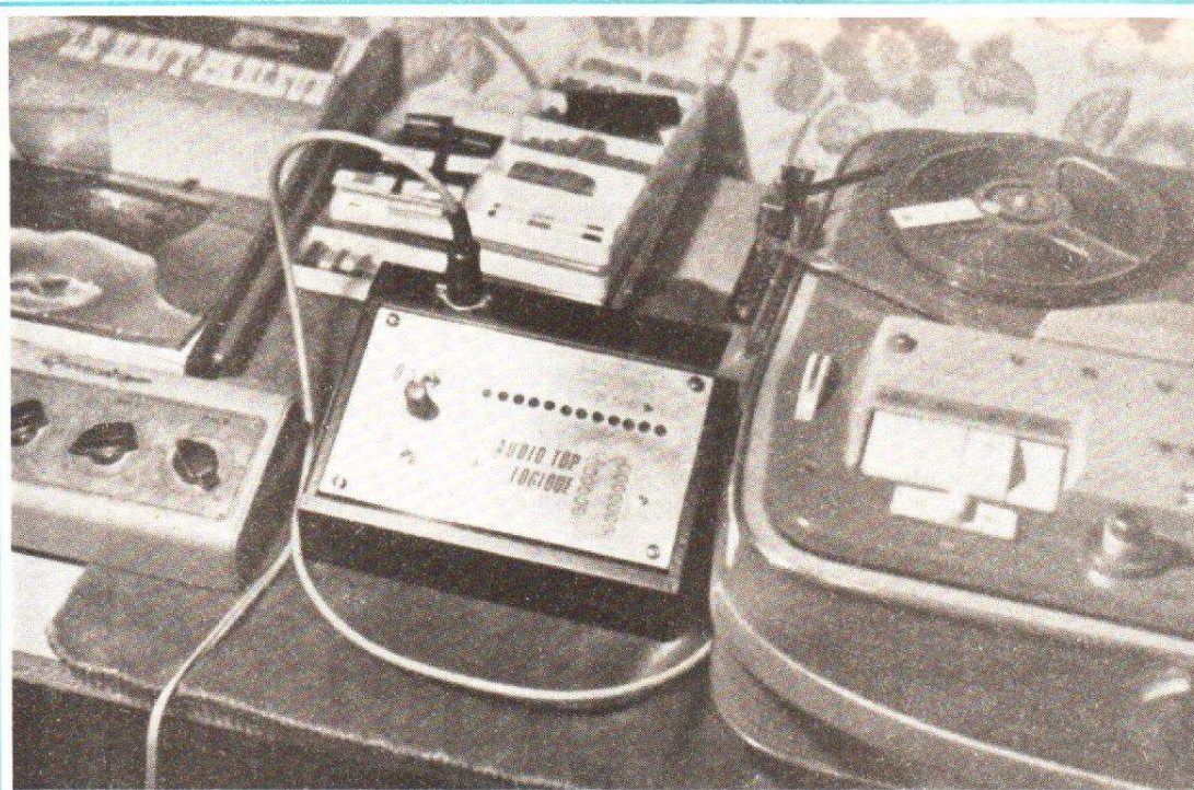
Fig. 16. - L'audio-top-logique dans sa version prototype. On voit la disposition adoptée pour la face avant. On remarque également la fixation de la tête de lecture supplémentaire sur notre
