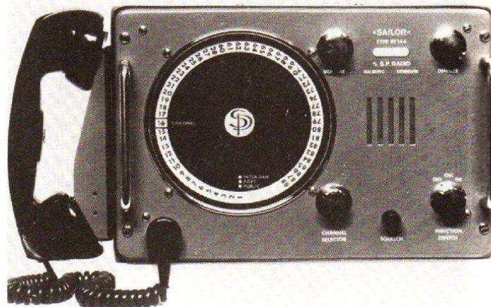
Photo 5. - Le radiotéléphone Sailor RT-144 fait appel à un synthétiseur numérique pour engendrer les fréquences. L'appareil ne comporte qu'un quartz pour la commande de tous les canaux internationaux et de 5 canaux privés. (Cliché Navigair).
