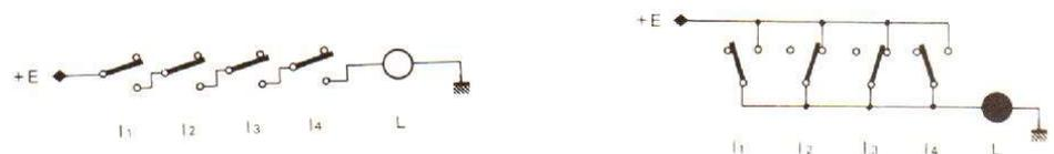
Fig. 3. - Fonctions ET et OU à quatre variables.
